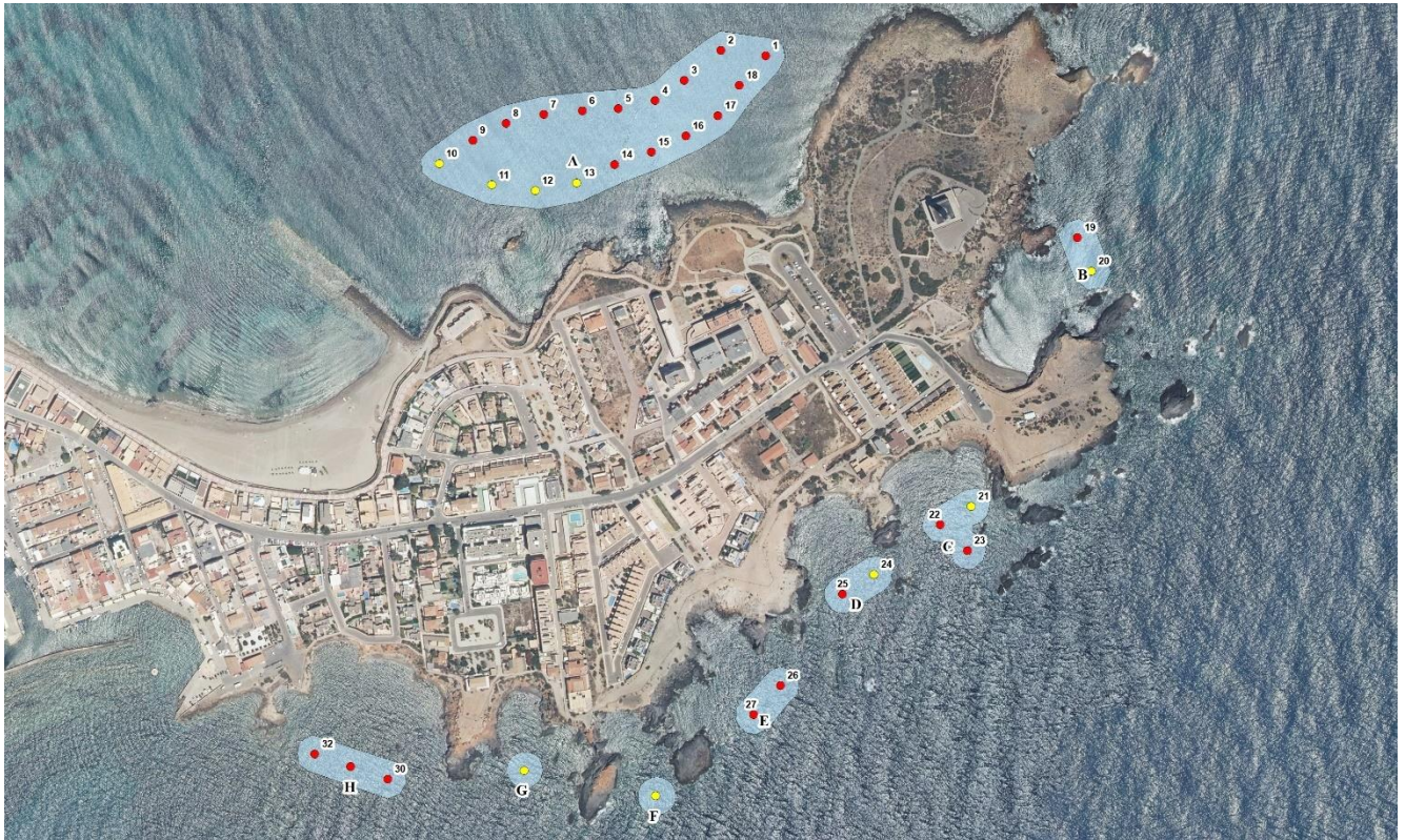
Imagen 6: Tipo de instalación. Boyas fijas (amarillas) y boyas desmontables (rojas)
