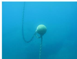
Imagen 7: Boya de flotabilidad para evitar el arrastre en el fondo
