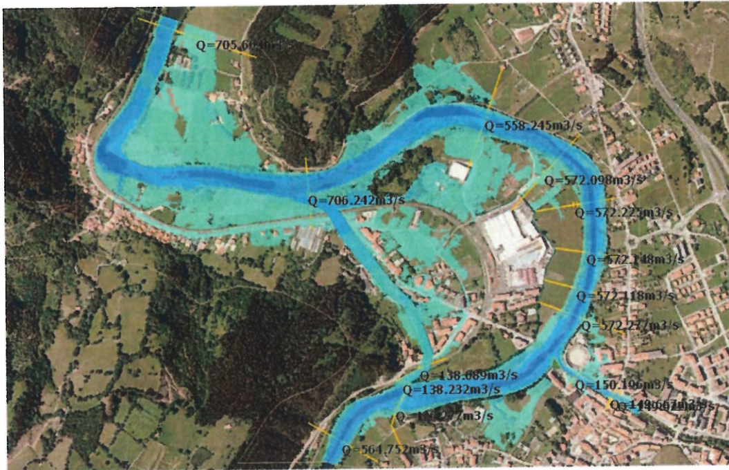
Figura 35. Análisis del canal de alivio de 30 metros. Q < 700 \text{ m}^3/\text{s}
