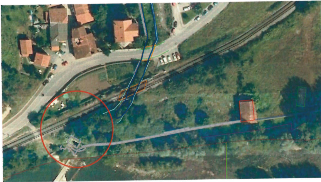
Figura 30. Inicio del canal donde se instalaría una compuerta de regulación. Antes de su paso bajo el ferrocarril y carretera.
