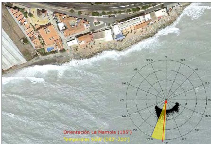
Figura 4.14 – Orientación del oleaje en la playa de Castillo de Baños
