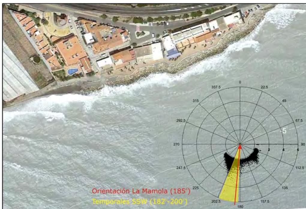
Figura 3.2 – Orientación del oleaje en la playa de Castillo de Baños
