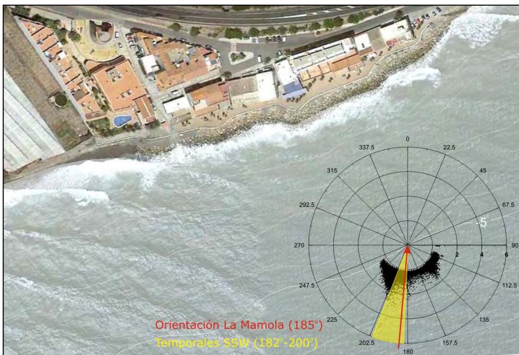
Figura 2.3 – Orientación del oleaje en la playa de Castillo de Baños
