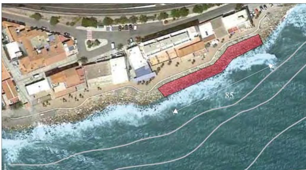
Figura 3.3 – Zona de extracción de escollera para su recolocación en el nuevo espigón
