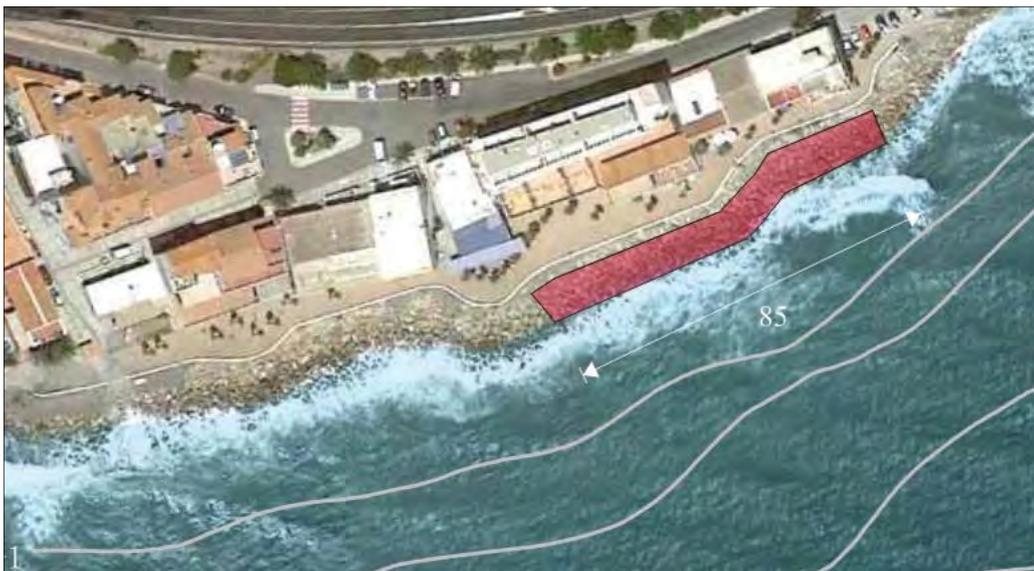
Figura 2.4 – Zona de extracción de escollera para su recolocación en el nuevo espigón
