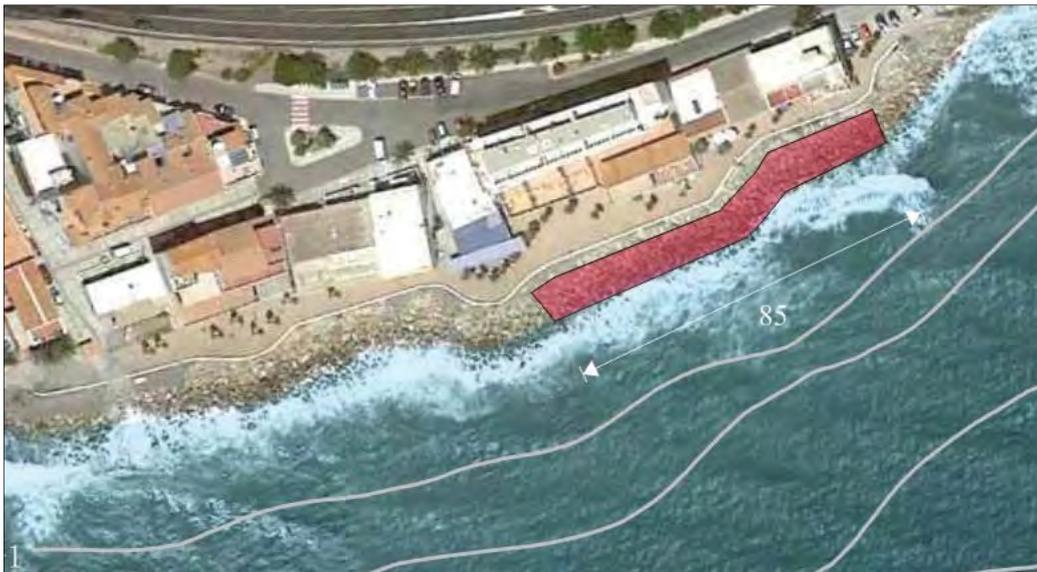
*Figura 1.3 – Zona de extracción de escollera para su recolocación en el nuevo espigón*
