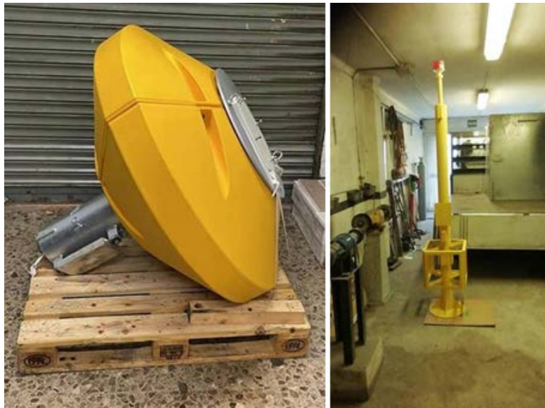
Flotador y un castillete típico para instalar los sensores.
