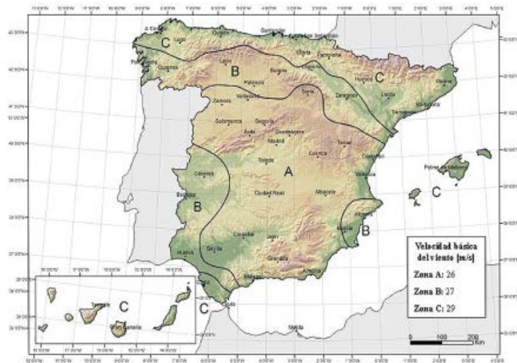
FIGURA 4.2-a MAPA DE ISOTACAS PARA LA OBTENCIÓN DE LA VELOCIDAD BÁSICA FUNDAMENTAL DEL VIENTO V_{b,0} (Coincide con el mapa correspondiente del Código Técnico de la Edificación)
