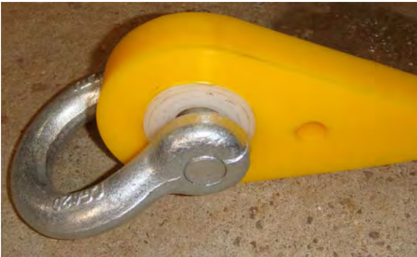
Detalle de pieza de sujeción a la brida de gran resistencia
