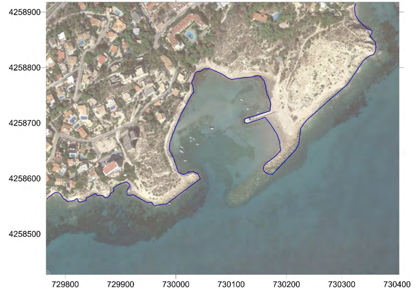
Imagen 32: Línea de costa del 22/09/2015 obtenida a partir de la digitalización de la imagen satelital de Google Earth para la Cala Morro Blanco. Fuente: Elaboración propia.
