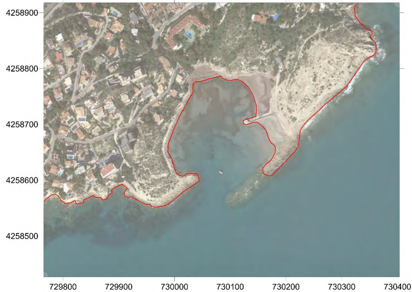
Imagen 33: Línea de costa del 11/11/2016 obtenida a partir de la digitalización de la imagen satelital de Google Earth para la Cala Morro Blanco. Fuente: Elaboración propia.
