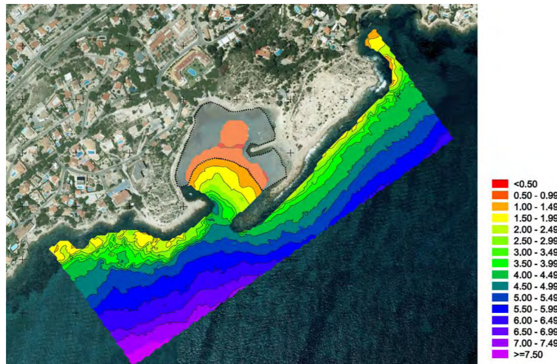
Imagen 1 : Aterramiento de la Cala Morro Blanco sobre el levantamiento batimétrico realizado. Fuente: Elaboración propia.
