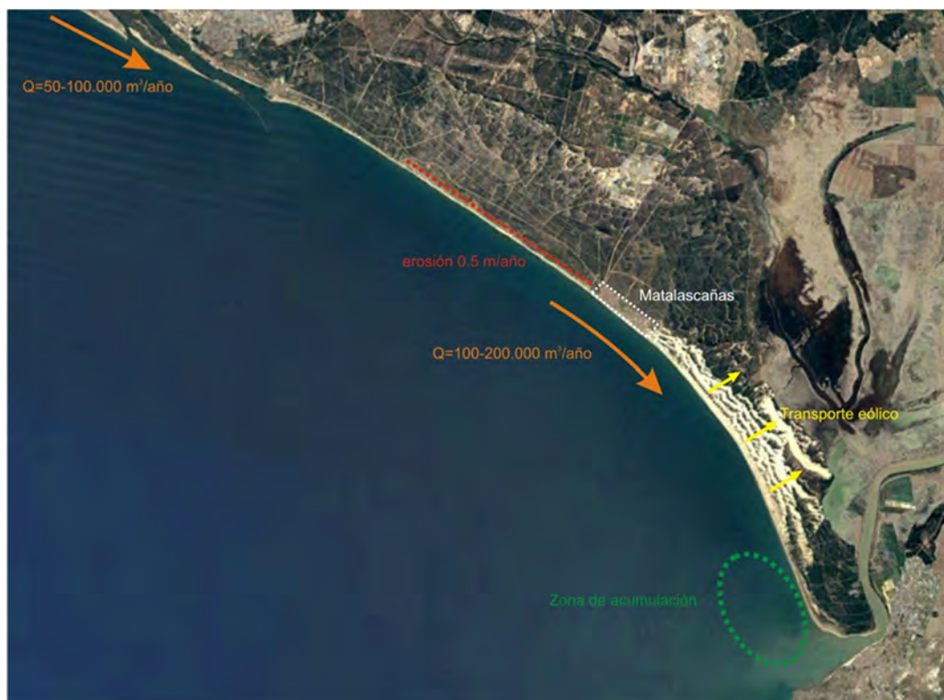
Figura 5.18 – Esquema de los procesos sedimentarios en el entorno de Matalascañas
