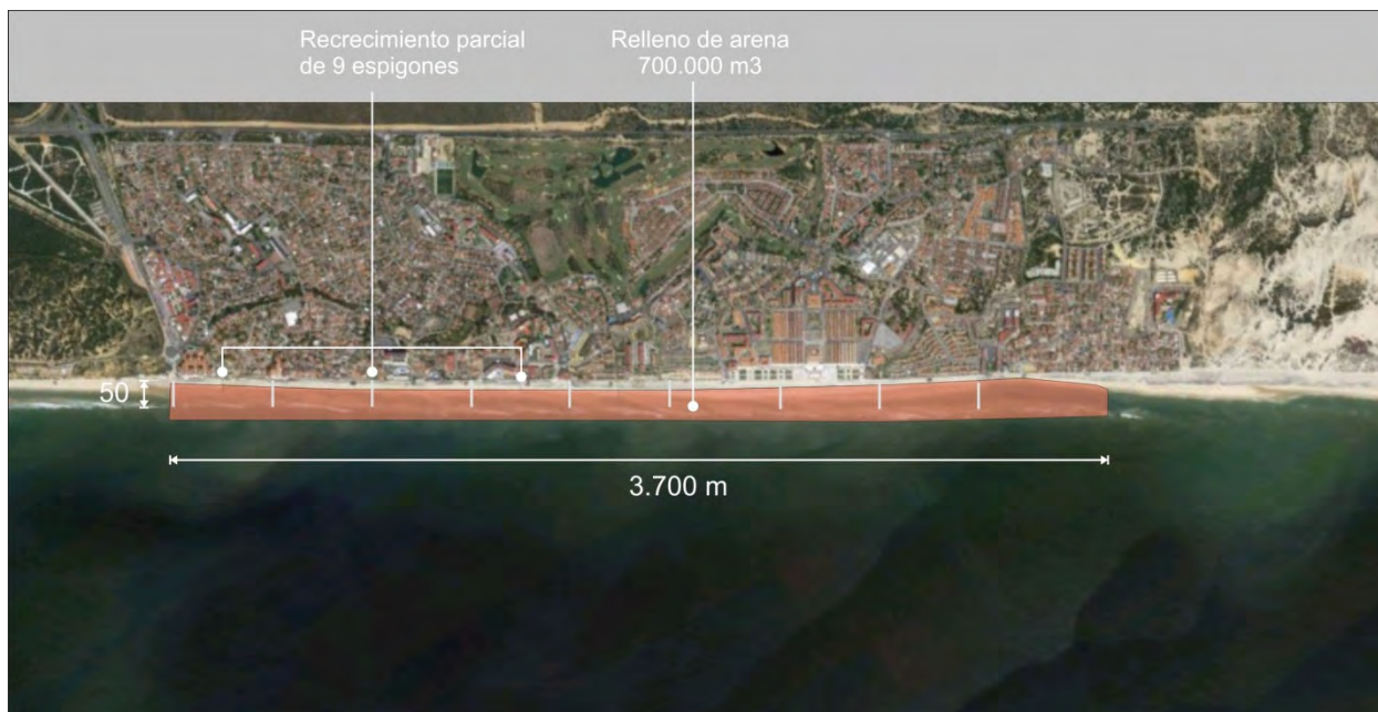
Figura 3.1 – Esquema de las obras de regeneración
