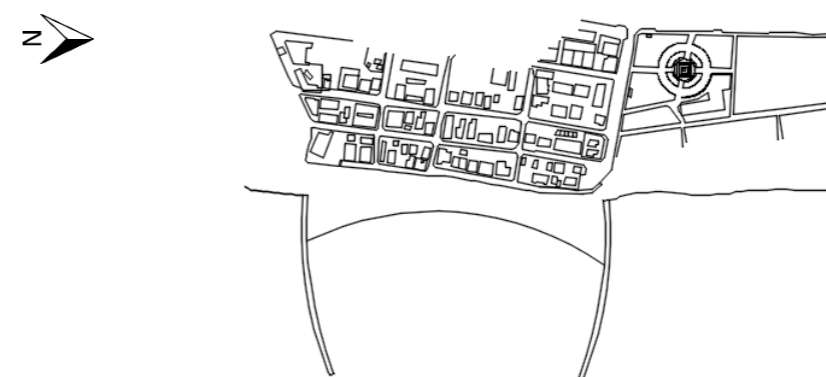
Imagen 11: Forma en planta de la alternativa 3: espigones curvos, de la playa del Mojón. Fuente: Elaboración propia.
