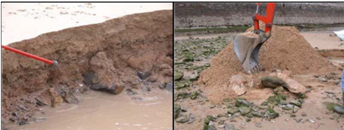
Figura 17. Piedras presentes en el lado oeste de la playa de Ondarreta: (a) debajo de una capa de arena en la línea de media marea; (b) en superficie y en sub-superficie en las proximidades de la línea de bajamar (AZTI).”
