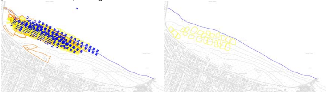
2020-2021. Izda: Recogidas. Trazado del tractor-despedregadora, limpiaplayas y utilización puntual de miniretro, con lugares de volcado de dicha retirada. Dcha: Devolución de arena.
