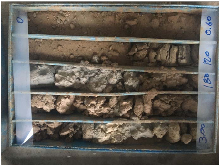
Foto 4: Caja porta testigos SONDEO 1 CAJA 1
