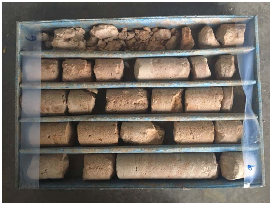
Foto 6: Caja porta testigos SONDEO 1 CAJA 3
