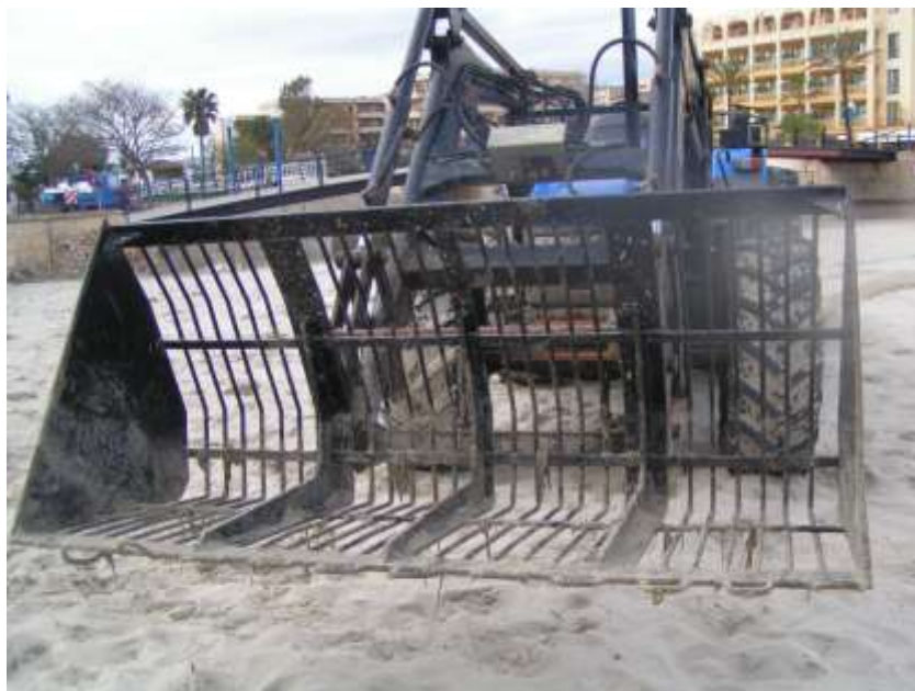
FIG. 4 PALA DEL TRACTOR QUE REALITZA LA RECOLLIDA DE POSIDONIA OCEANICA AL MUNICIPI DE MANACOR DES DEL 2007, PROPIETAT DE EL MATAMBRITO.
