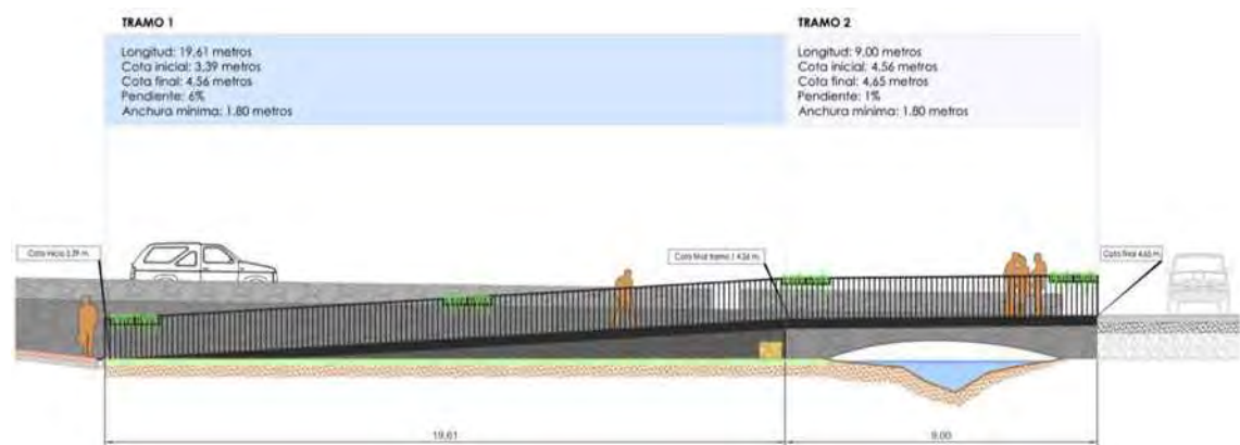
Imagen 2. Alzado rampa y pasarela peatonal
