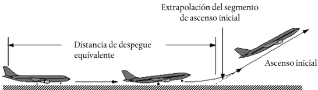
En una pista horizontal, la distancia equivalente del desplazamiento en tierra al despegue  $s_{TO8}$  en pies es determinada a partir de
