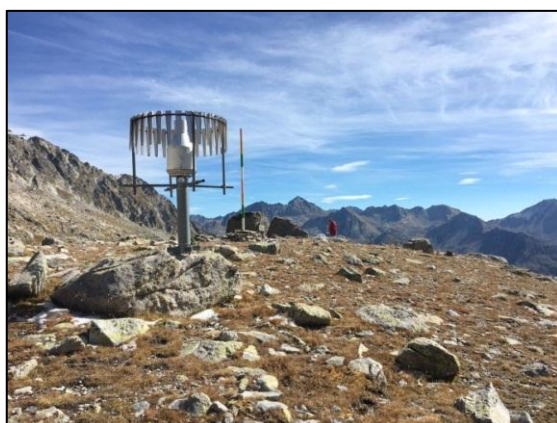
Foto 16. Estació meteorològica de Contraix i balisa de neu reubicada al fons
