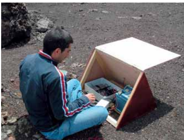
Figura 3. a) Montaje de la electrónica y panel solar de la estación sísmica autónoma de Timanfaya. b) Aspecto de la estación sísmica una vez completada su instalación.
