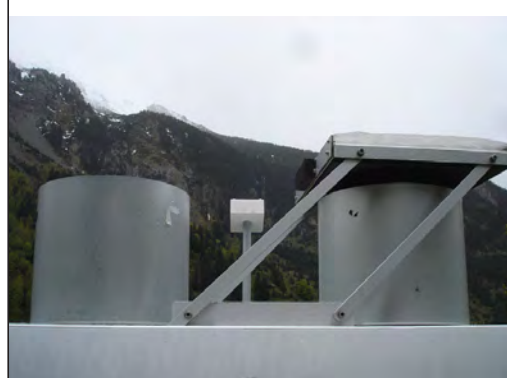
Foto 2. Colector atmosférico pasivo automático conectado a una célula higrosensible localizado dentro de la zona protegida del Parque Nacional d'Aigüestortes con contenedores de precipitación seca y húmeda.
