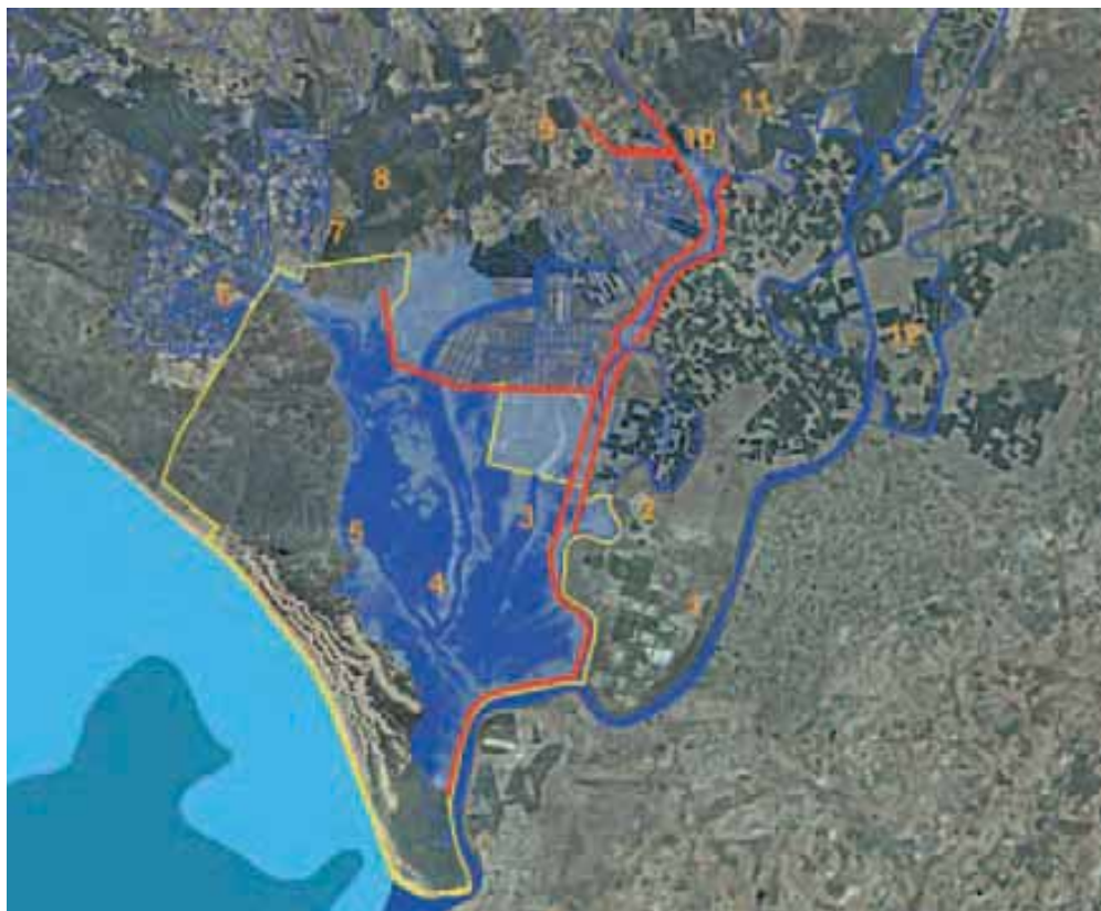
Figura 3. Red hidrográfica transformada de la marisma; en una primera etapa, se produjeron los encauzamientos del río Guadalquivir, así como las modificaciones hidrológicas para la agricultura (1947-1977); en la segunda etapa, se procuró la regeneración hídrica de la marisma (1982-1987), aunque sus actuaciones también causaron importantes impactos en Doñana, debido a la ausencia tanto del conocimiento científico preciso como de una visión holística de todo el sistema. 1. Río Guadalquivir; 2. Brazo de la Torre; 3. Caño Travieso; 4. Caño Guadamar; 5. Madre de las Marismas; 6. Arroyo de la Rocina; 7. Arroyo del Partido; 8. Arroyo Cañada Mayor; 9. Arroyo de la Cigüeña; 10. Río Guadamar; 11. Arroyo de Majaberraque; 12. Brazo del Este.
