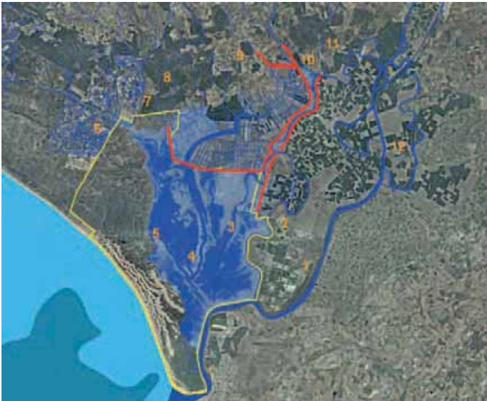
Figura 4. Red hidrográfica recuperada de la marisma; pueden observarse en el esquema las actuaciones del Proyecto Doñana 2005, que han permitido la ampliación del Parque Nacional de Doñana con la finca de Caracoles, así como la restitución de cauces y eliminación de algunas barreras hidráulicas.
