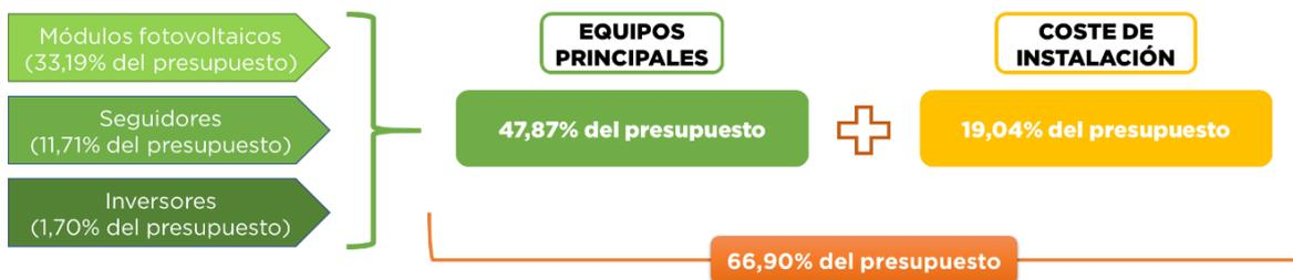
**Figura 2: Distribución de los principales elementos del presupuesto de la planta fotovoltaica. Elaboración propia**
