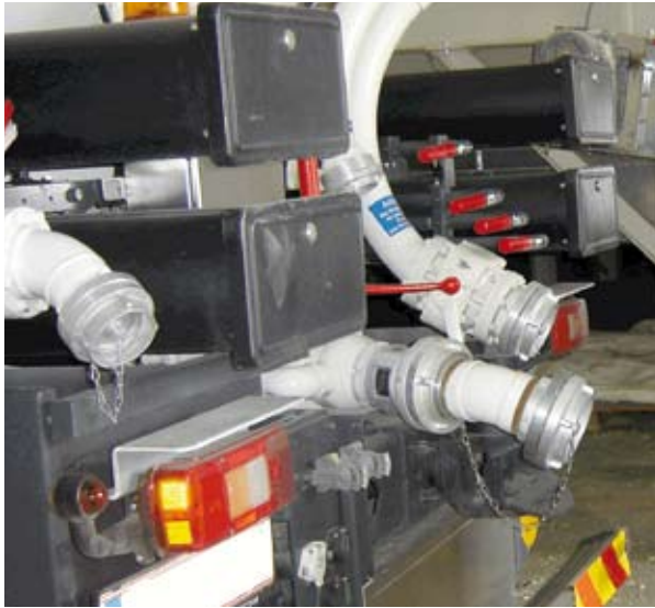
Figura 35: Detalle toberas camión cisterna
