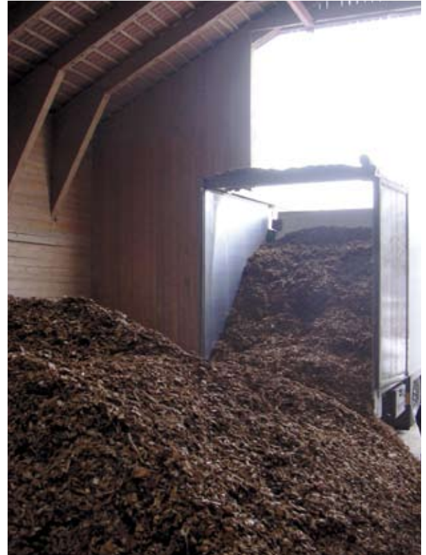
Figura 6: Camión de suministro con suelo móvil
