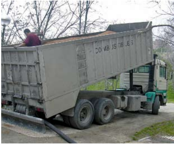
Figura 7: Camión de suministro tipo volquete con sistema neumático
