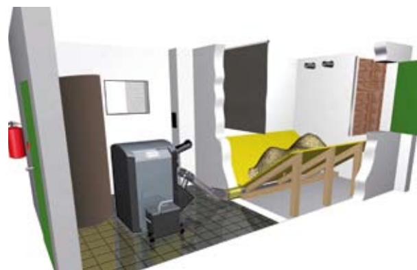
Figura 23: Almacenamiento con suelo inclinado de dos lados y tornillo sinfín en codo
