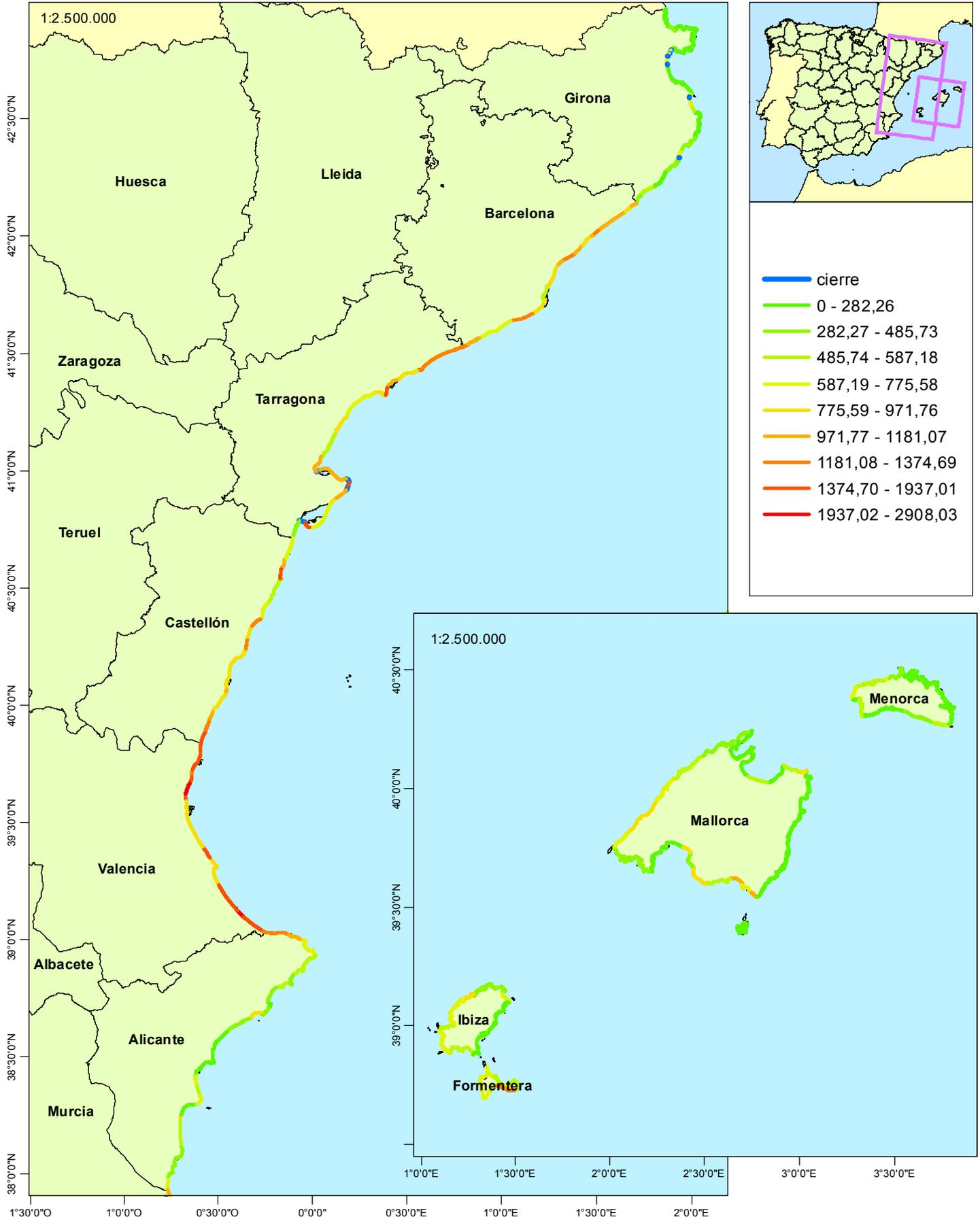
**LLEGADA POTENCIAL DE HIDROCARBURO. SEVERIDAD de la contaminación por fuel pesado: volumen de llegada dividido por la longitud del tramo de costa ( $m^3/km$ ) que podría ser superado una vez cada 1000 años.**
