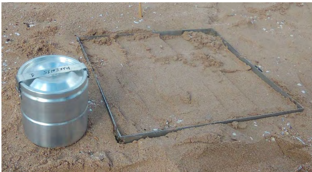
Figura 3. Marco metálico y contenedor utilizados en el muestreo
