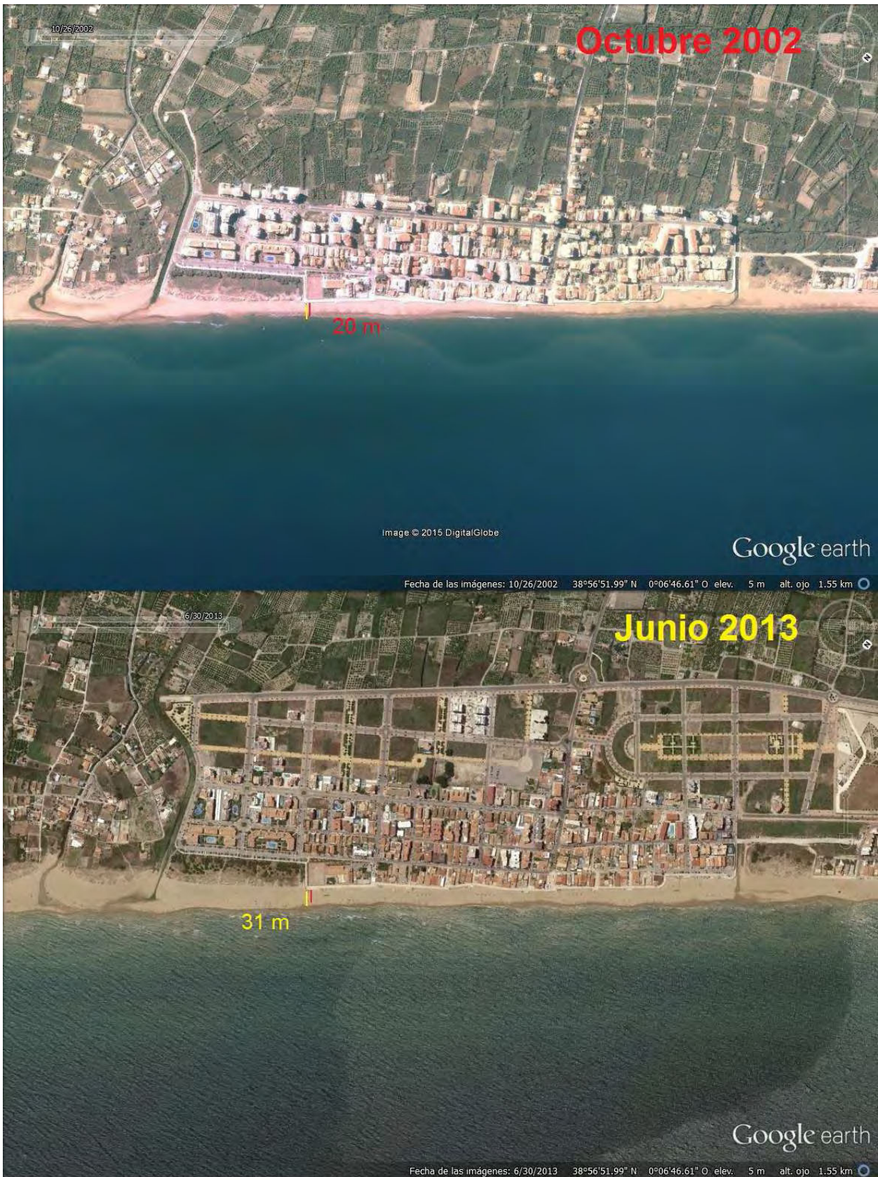
Figura 7.6: Estado de la playa de Piles en los años 2002 y 2013 (Foto: Google Earth)
