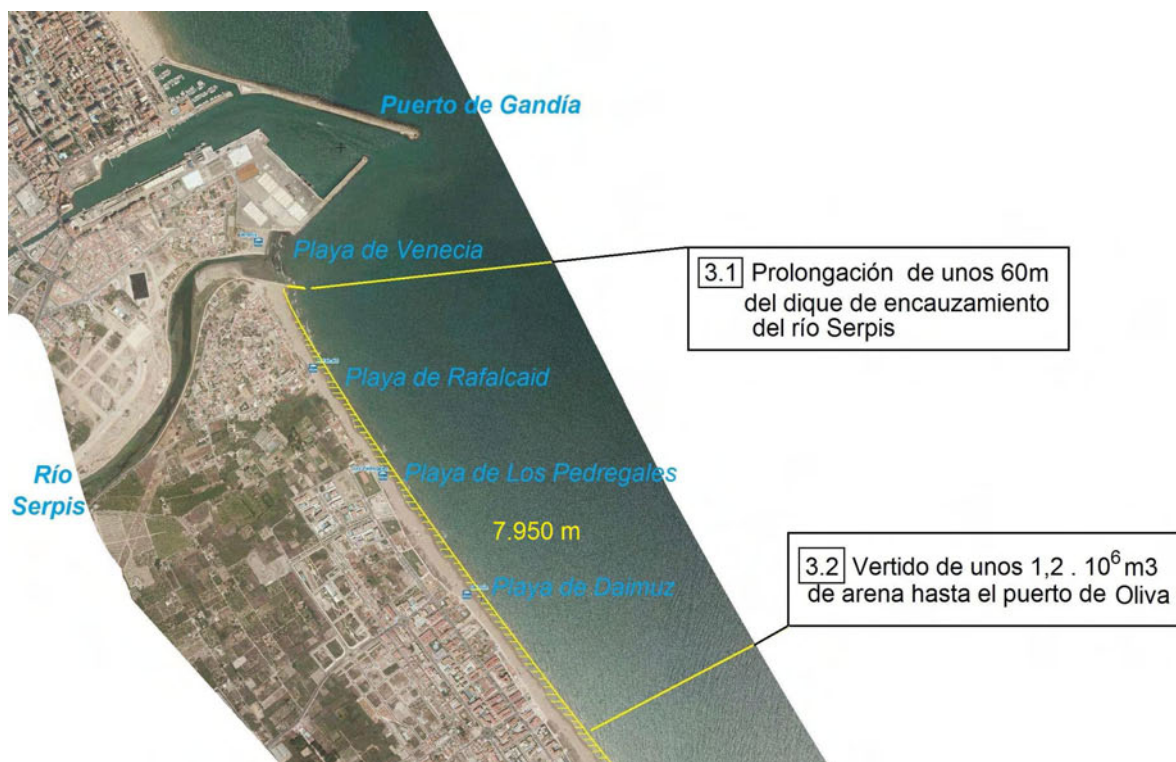
Figura 7.10: Actuaciones en el Tramo 3: Puerto de Gandía – Puerto de Oliva (Foto: MAGRAMA)
