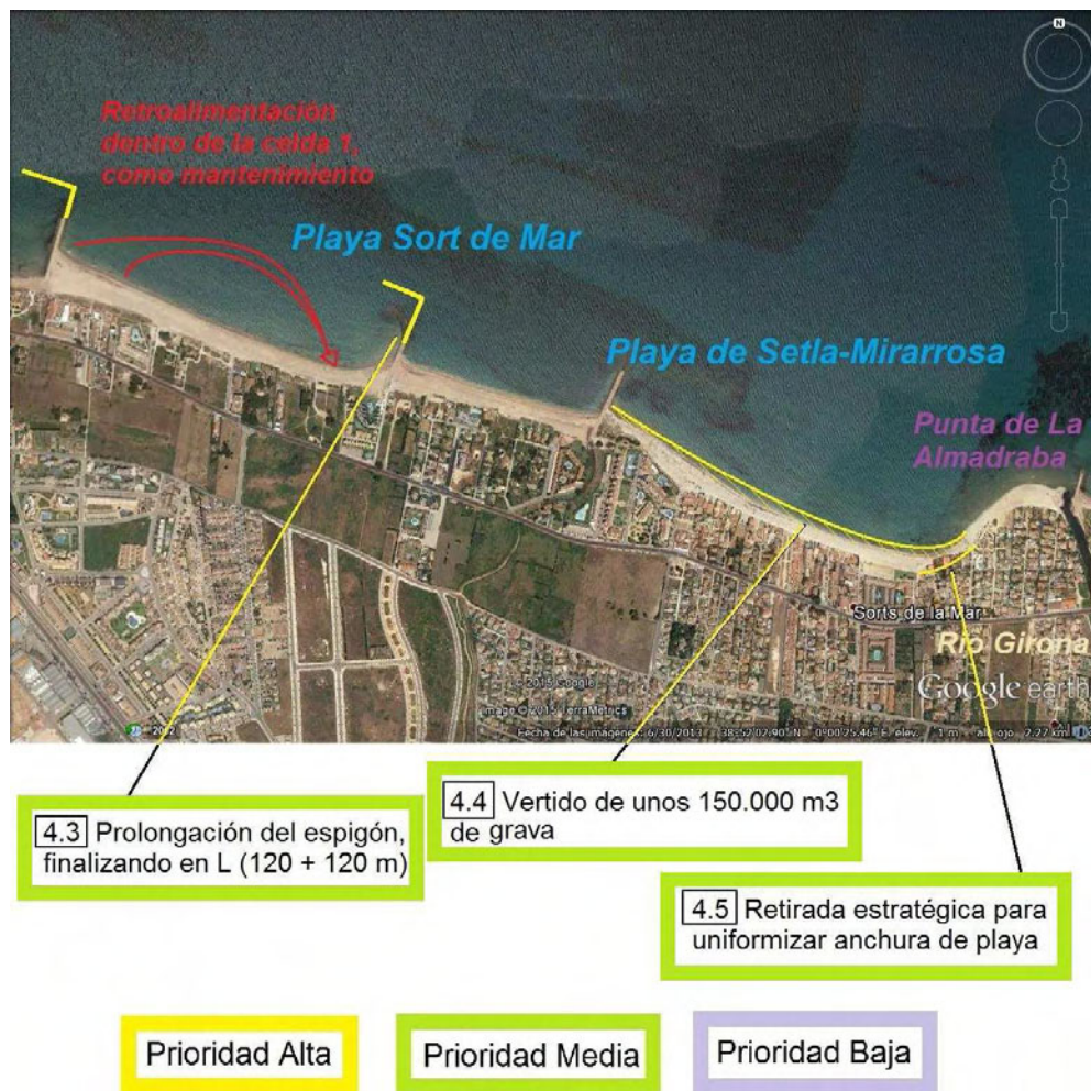
Figura 9.7: Prioridades de actuación en el Tramo 4, sub tramo 2, playas de Sort de Mar y Setla-Mirarrosa (Foto: TerraMetrics y Google Earth)
