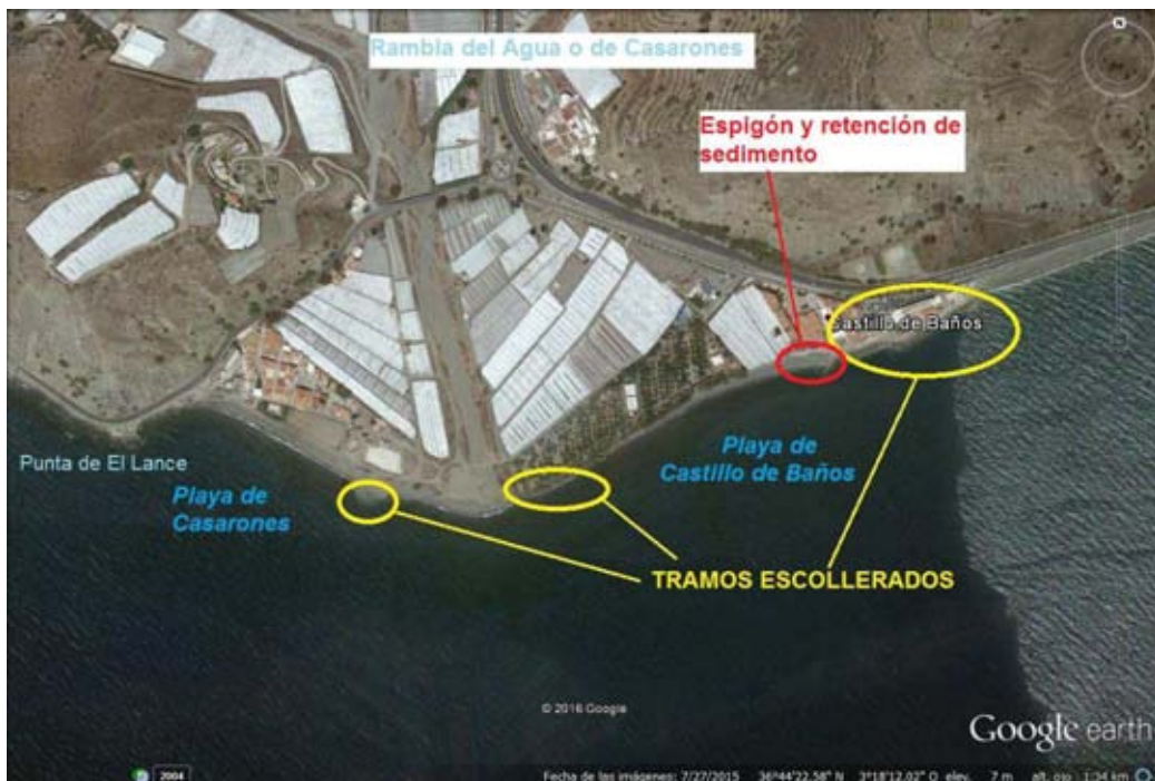
Figura 11.5: Comportamiento y zonas singulares en las playas de Casarones y Castillo de Baños (Foto: Google Earth)
