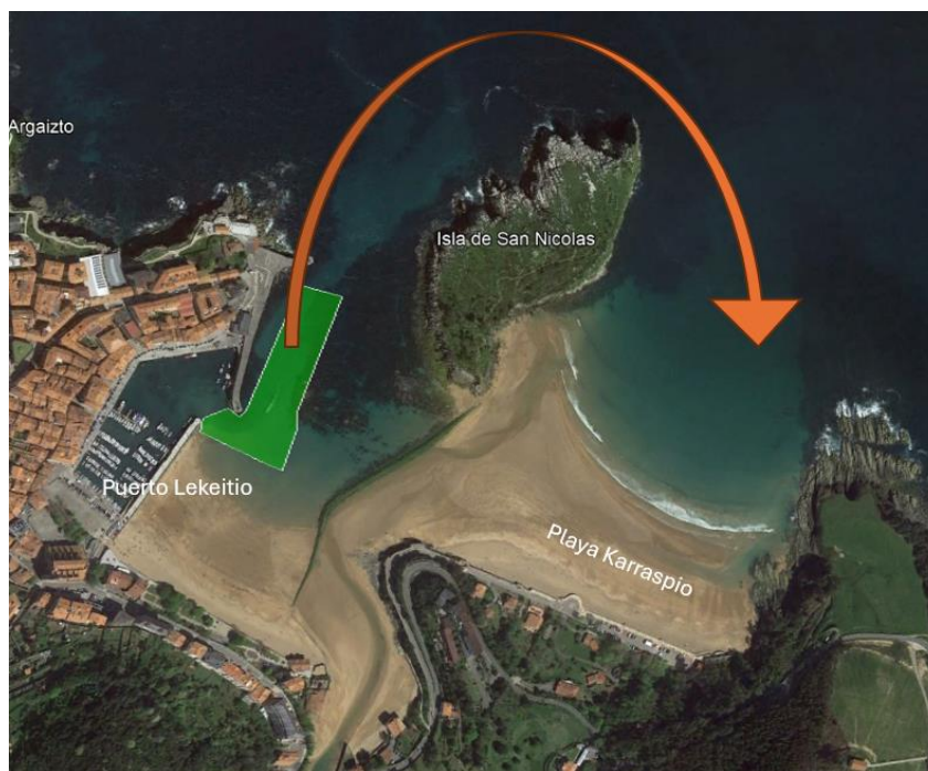
Figura 3. Reubicación de las arenas dragadas en el canal de acceso del puerto de Lekeitio.
