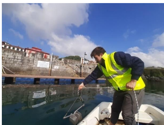
Figura 13. Toma de muestras mediante draga Van Veen.
