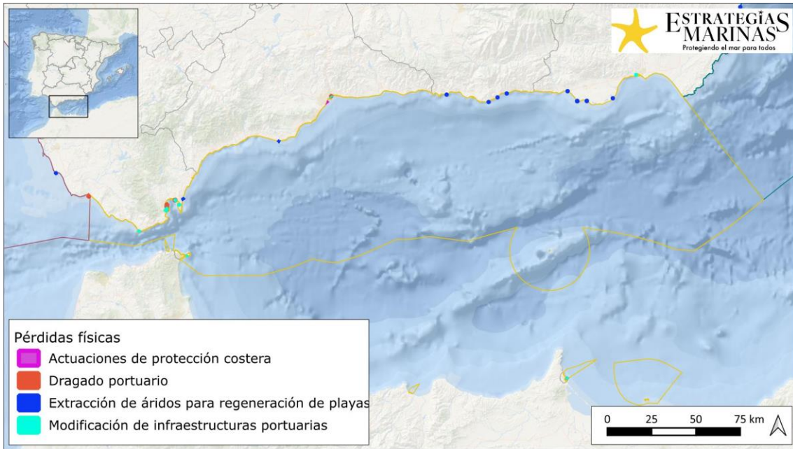
Figura 26. Localización de potenciales pérdidas físicas en el periodo 2016-2021. (Fuente: Figura elaborada por el CEDEX)
