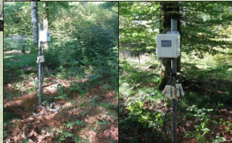
Sondas humedad y temperatura del suelo
