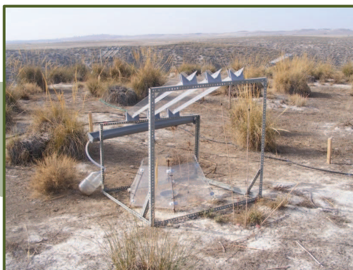
Figura 3. Reductores de precipitación y cúpula de metacrilato inductora de calentamiento en la parcela experimental de Aranjuez.
