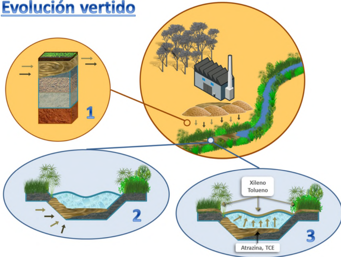
Figura 8. Modelización de la evolución de las aguas de extinción retenidas en el dique contaminadas por tolueno, xileno, tricloroetileno y atrazina: contaminación del suelo y descarga al río R, afectando al lecho del río, al agua superficial y a las riberas del río R. Fuente: Elaboración propia
