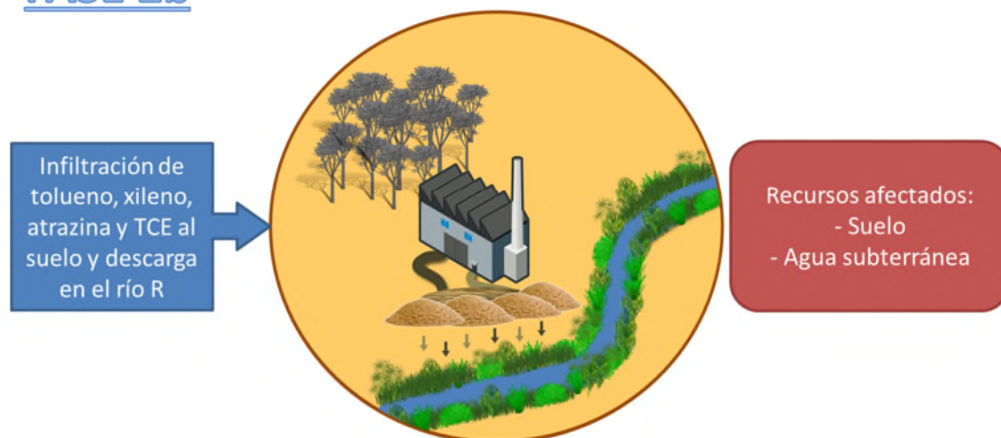
Figura 3. Fase 2b del incidente: infiltración de las aguas de extinción retenidas en el dique y contaminadas por tolueno, xileno, tricloroetileno y atrazina al suelo y a las aguas subterráneas. Fuente: Elaboración propia
