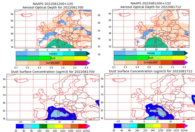
Espesor óptico de aerosoles a 550 nm (arriba) y concentración de polvo a nivel de superficie (abajo) previstos por el modelo NAAPs para el día 17 de agosto de 2022 a las 00 h UTC y a las 12 h UTC. ©Naval Research Laboratory (NRL), Monterey, CA.
