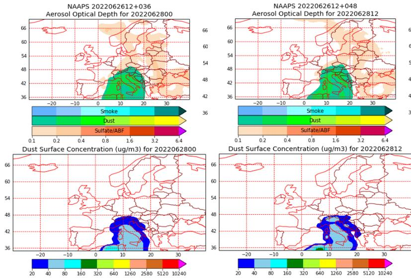
Espesor óptico de aerosoles a 550 nm (arriba) y concentración de polvo a nivel de superficie (abajo) previstos por el modelo NAAPS para el día 28 de junio de 2022 a las 00 h UTC y a las 12 h UTC. ©Naval Research Laboratory (NRL), Monterey, CA.
