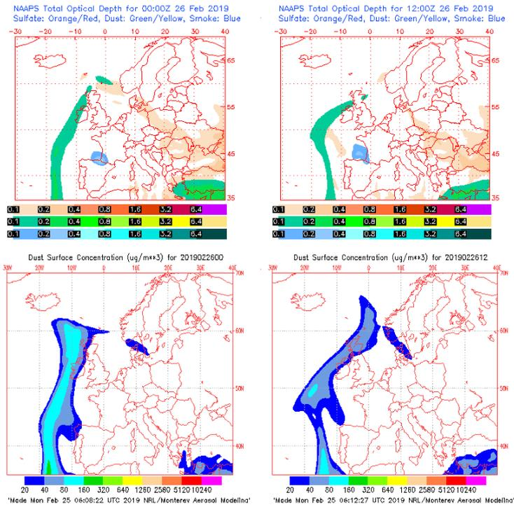
Espesor óptico de aerosoles a 550 nm (arriba) y concentración de polvo a nivel de superficie (abajo) previstos por el modelo NAAPS para el día 26 de febrero de 2019 a las 00 UTC y a las 12 UTC. ©Naval Research Laboratory (NRL), Monterey, CA.
