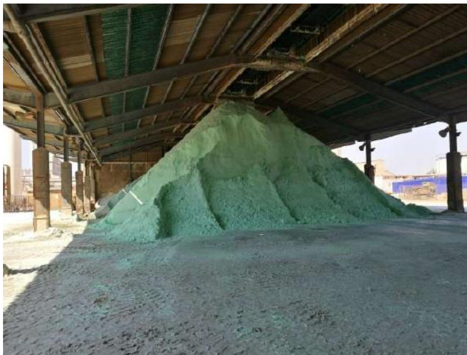
Gráfico 2.1.2-1. Sulfato ferroso heptahidratado (Caparrosa). Instalaciones de Venator.
