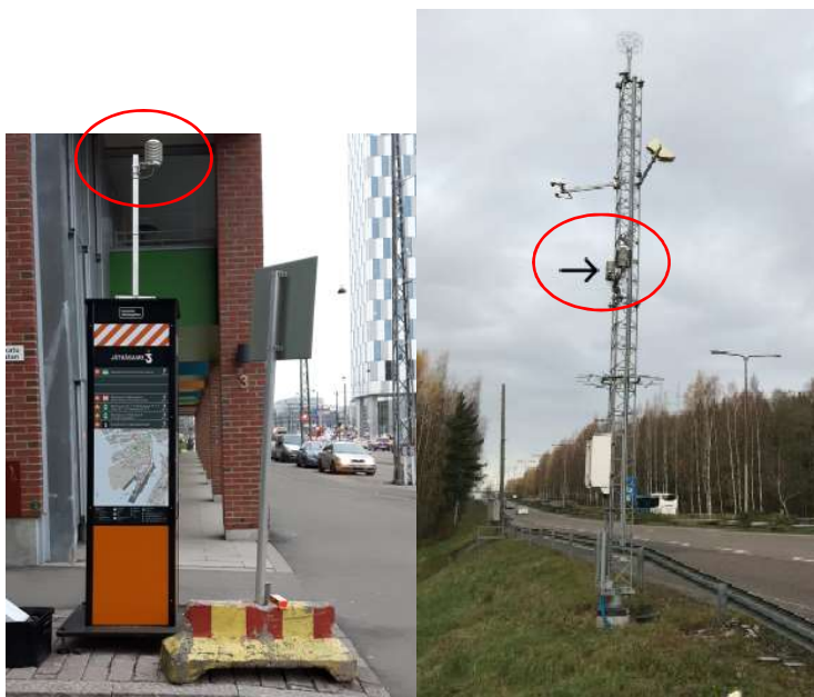
15 sensores AQT420 instalados
