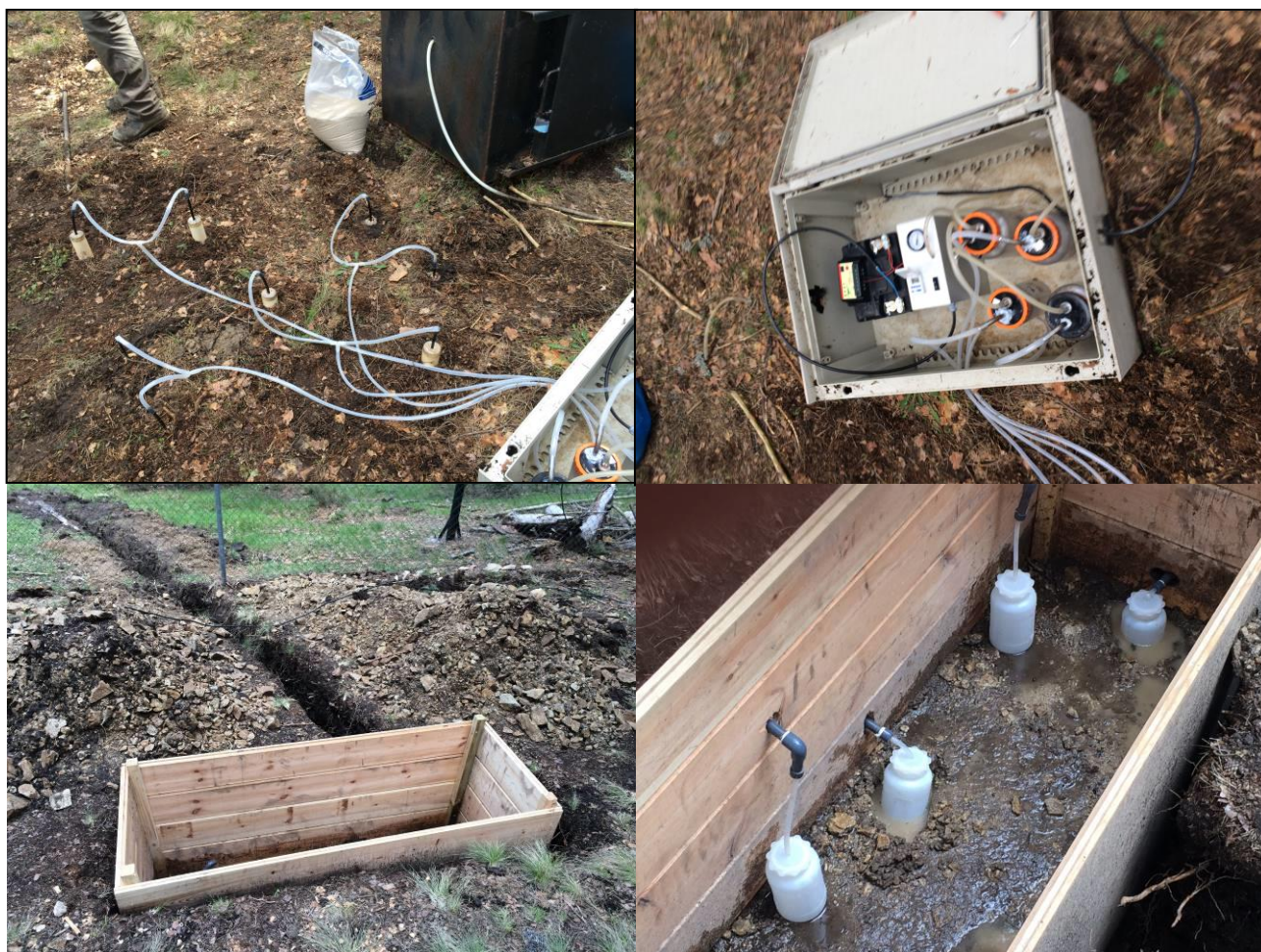
FIG 39: Lisímetros de tensión para extracción de agua del suelo y bomba de vacío. Lisímetro de gravedad, zanja de drenaje y toma de muestras.
