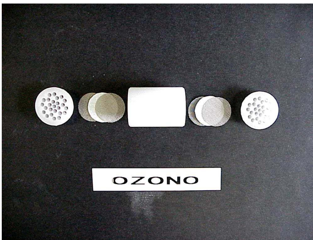
Figura 1A. Dosímetro de ozono utilizado hasta abril. A) Dosímetro de ozono desmontado. De izquierda a derecha: tapón de polipropileno con 24 perforaciones de 1,5 mm, malla de acero inoxidable (0,3 mm de paso de malla), filtro de fibra de vidrio impregnado con la solución captadora, cuerpo de polipropileno, y a continuación otra vez las partes mencionadas en orden inverso.
