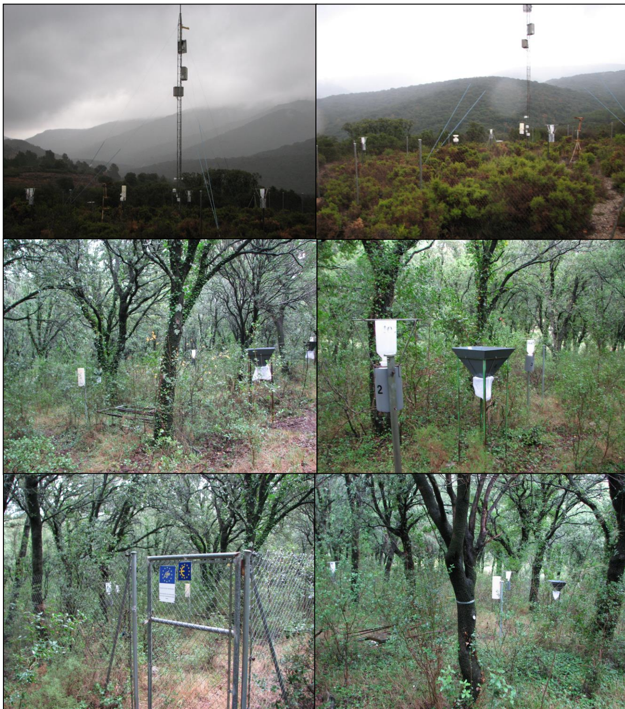
FIG 7: Parcela exterior. Torre meteorológica y captadores. Parcela interior. Acumuladores de deposición. Captador de desfronde. Pluviómetro. Dialdendro
