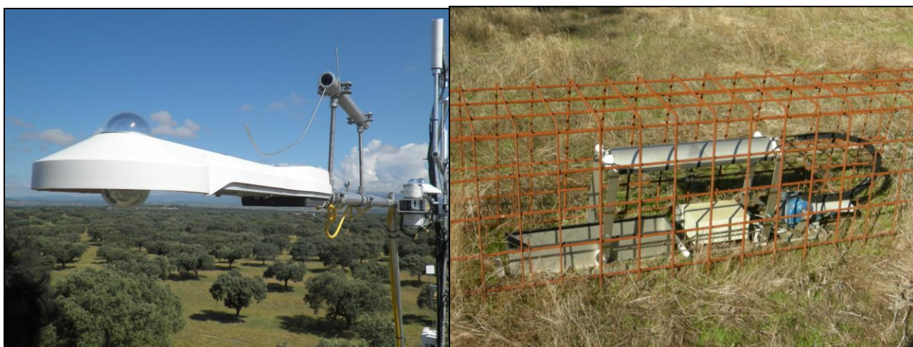
FIG 7b: Instrumentación para medición de radiación solar e infrarroja. Respirador de suelo.
