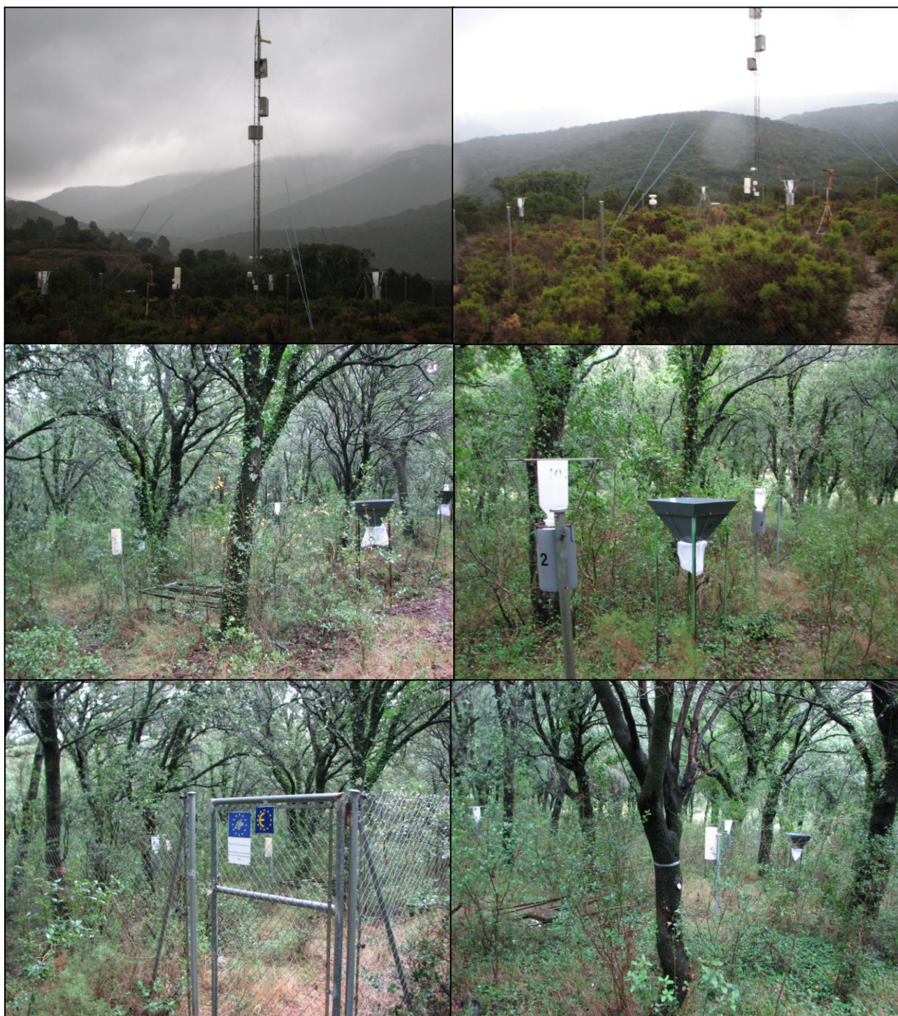
FIG 7: Parcela exterior. Torre meteorológica y captadores. Parcela interior. Acumuladores de deposición. Captador de desfronde. Pluviómetro. Dialdendro
