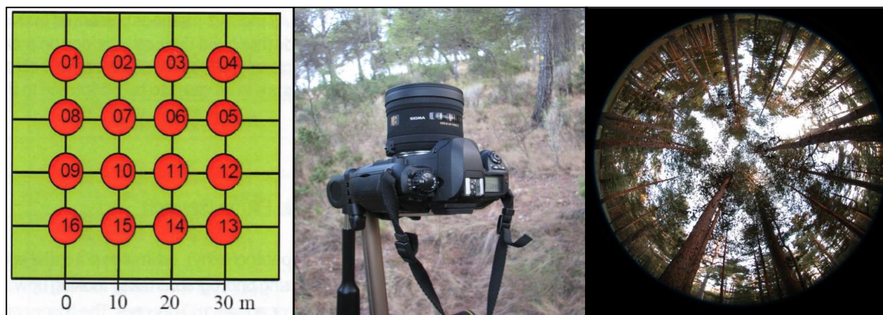
FIG 37: Medición en campo del parámetro LAI. Cuadrícula de observación. Cámara hemisférica. Fotografía del vuelo.
