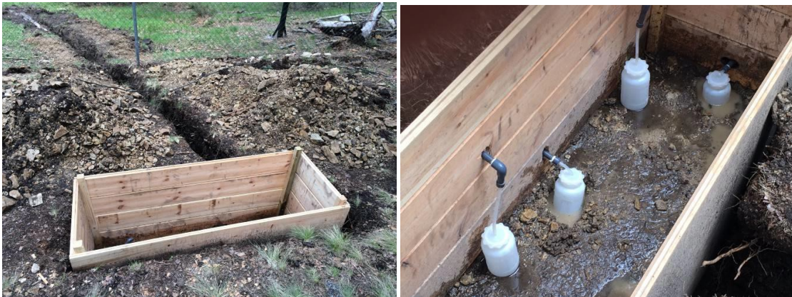
Figura 2: Lisímetros de gravedad para extracción de agua del suelo
