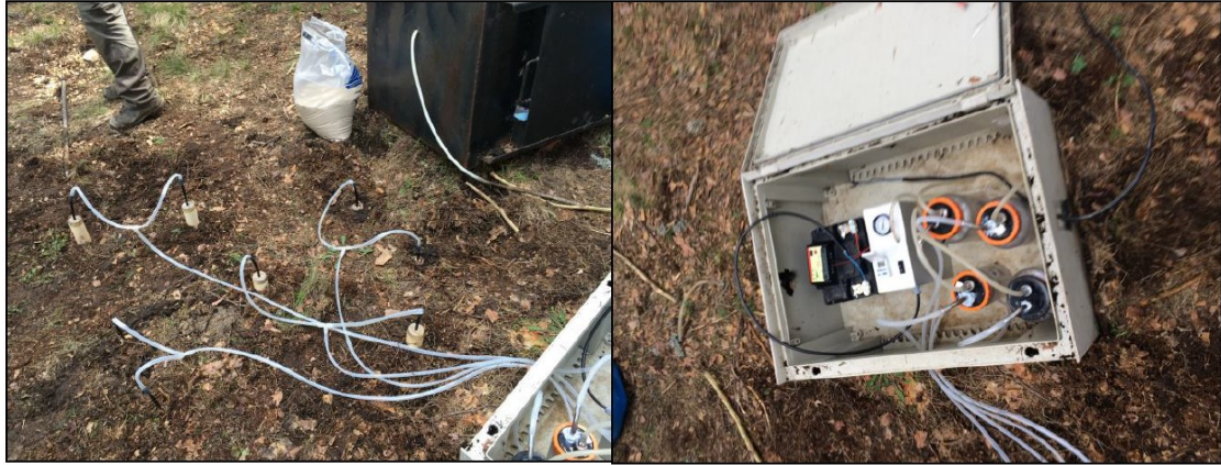
Figura 1: Lisímetros de tensión para extracción de agua del suelo y bomba de vacío
