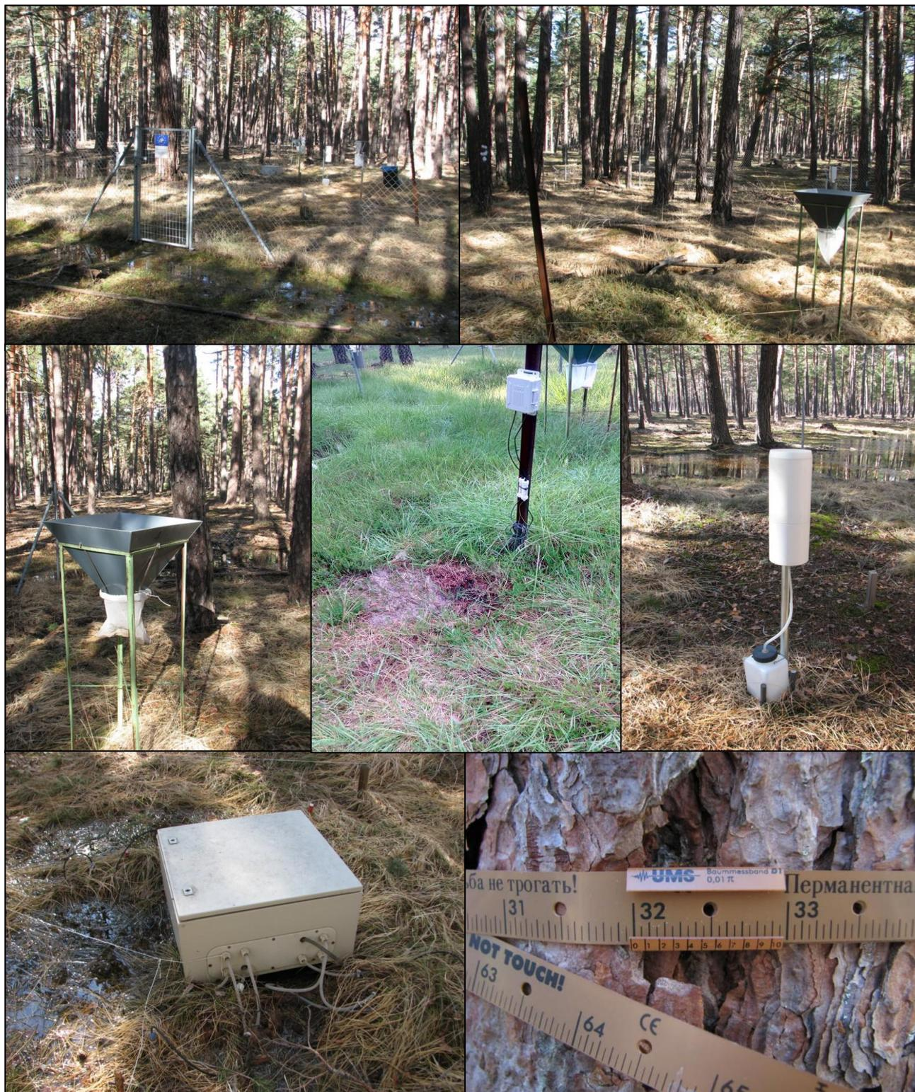
**FIG 7:** Parcela interior. Acumuladores de deposición. Captador de desfonde. Sonda de humedad. Pluviómetro. Caja de lisímetros. Dialdendro
