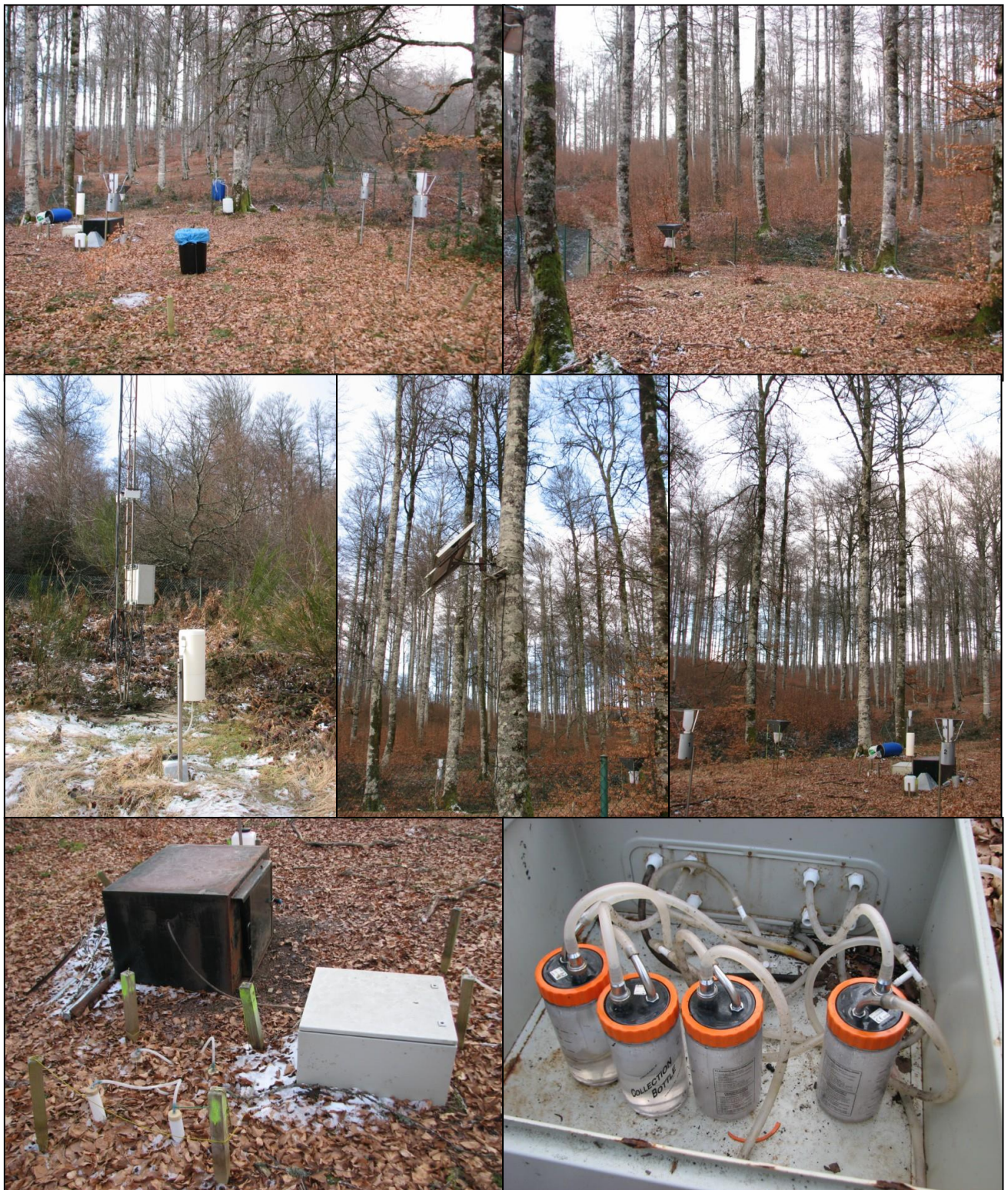
FIG 7: Parcela interior, acumuladores de deposición, captador de desfronde. Estación meteorológica. Lisímetros
