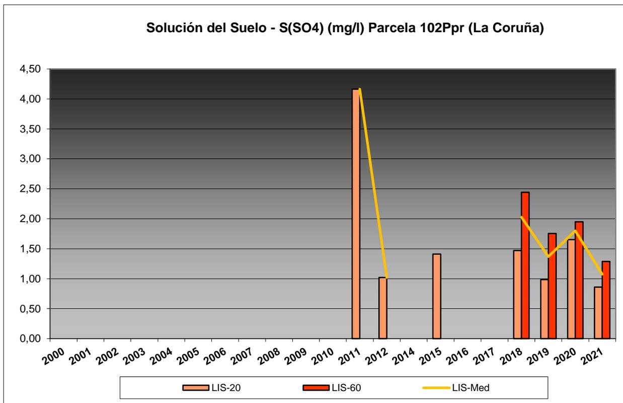
FIG 43: Contenido en S(SO<sub>4</sub>) solución del suelo a 20 y 60 cm de profundidad.
