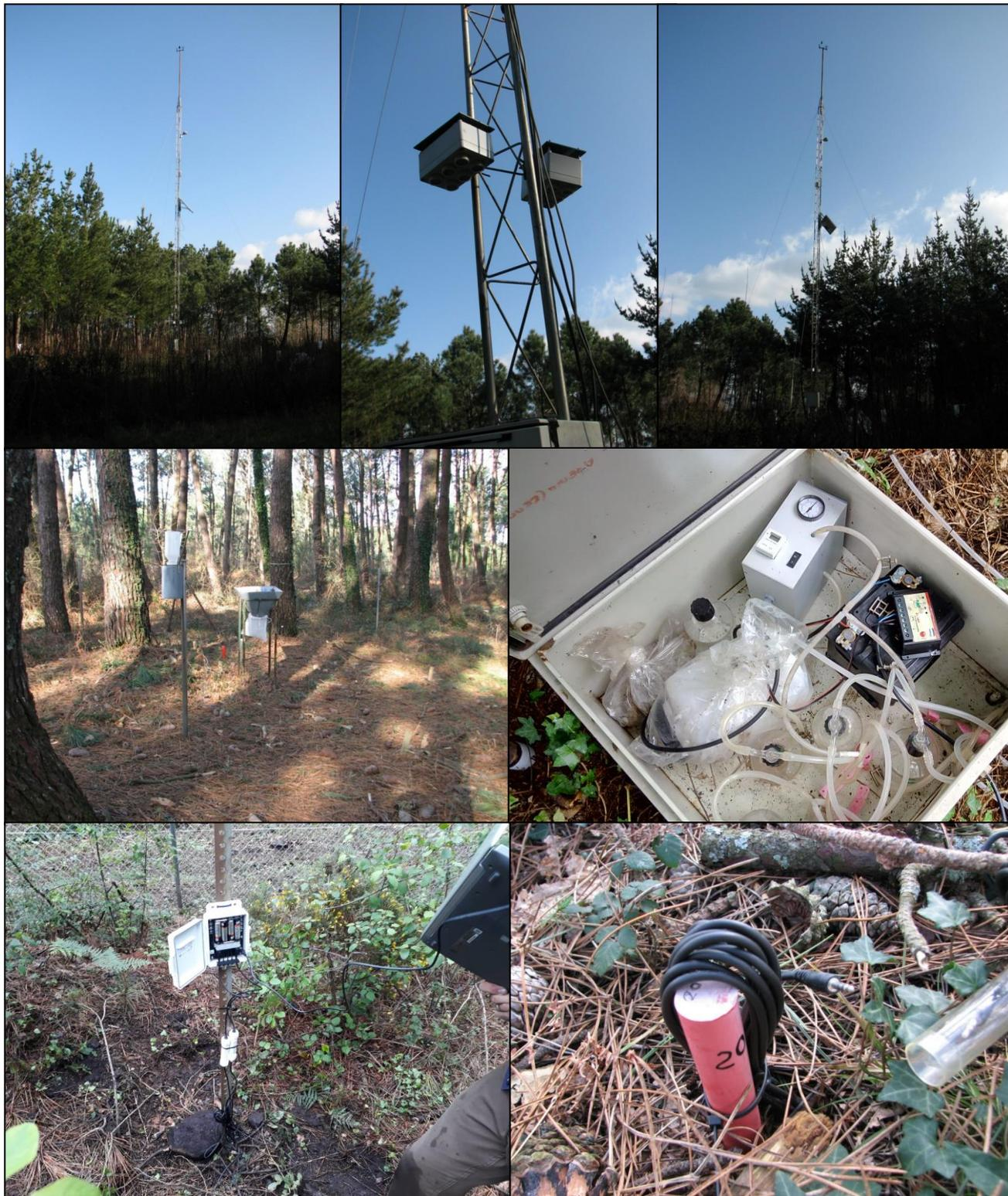
**FIG 7:** Parcela exterior, torre meteorológica y dosímetros. Parcela interior, captadores. Caja de lisímetros. Sondas de humedad
