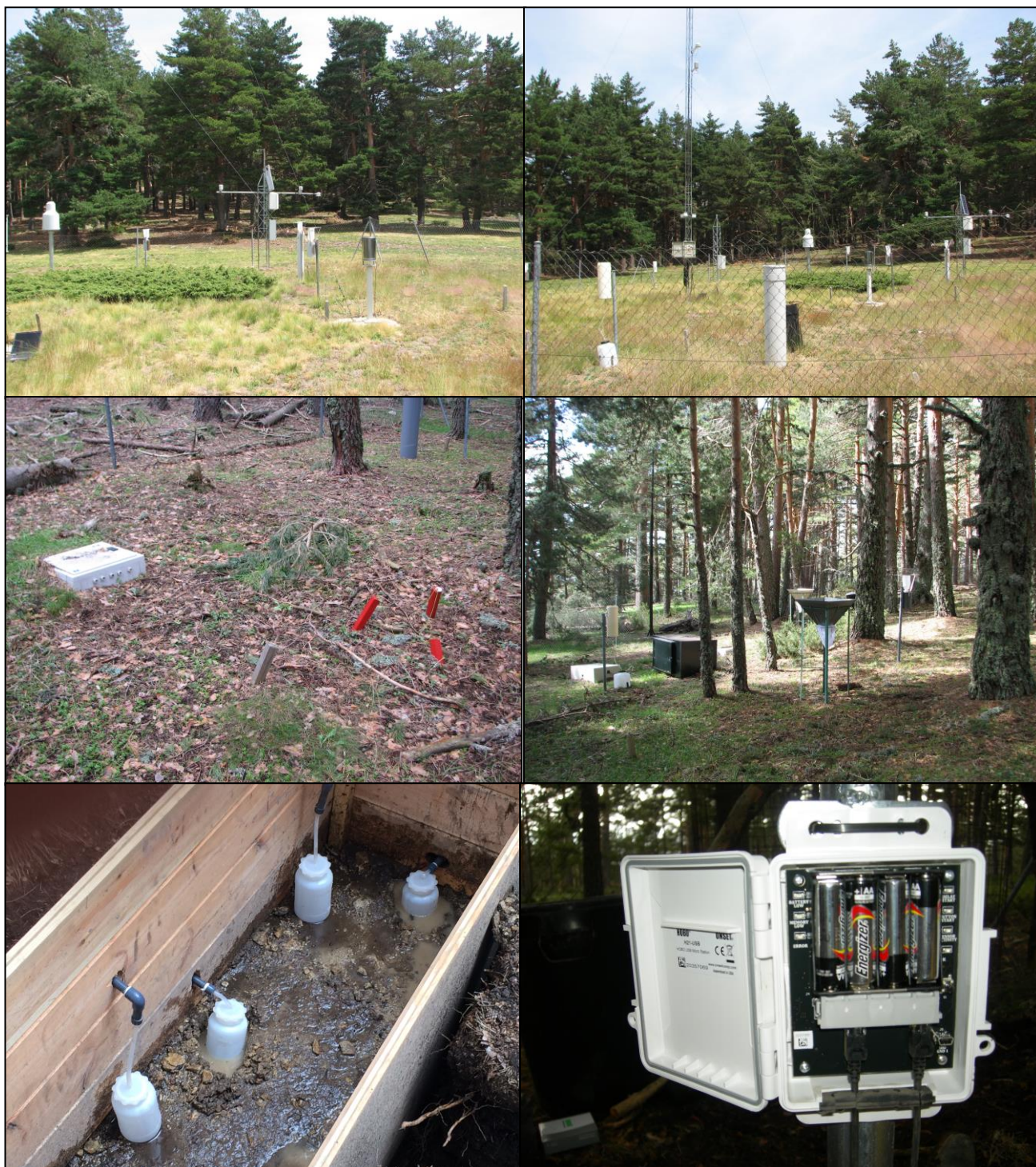
FIG 7: Parcela exterior. Pluviómetros, captadores e instrumentación meteorológica. Parcela interior. Lisímetros, sondas de humedad, captadores de desfolle y acumuladores. Lisímetro de gravedad. Sonda de humedad y temperatura del suelo
