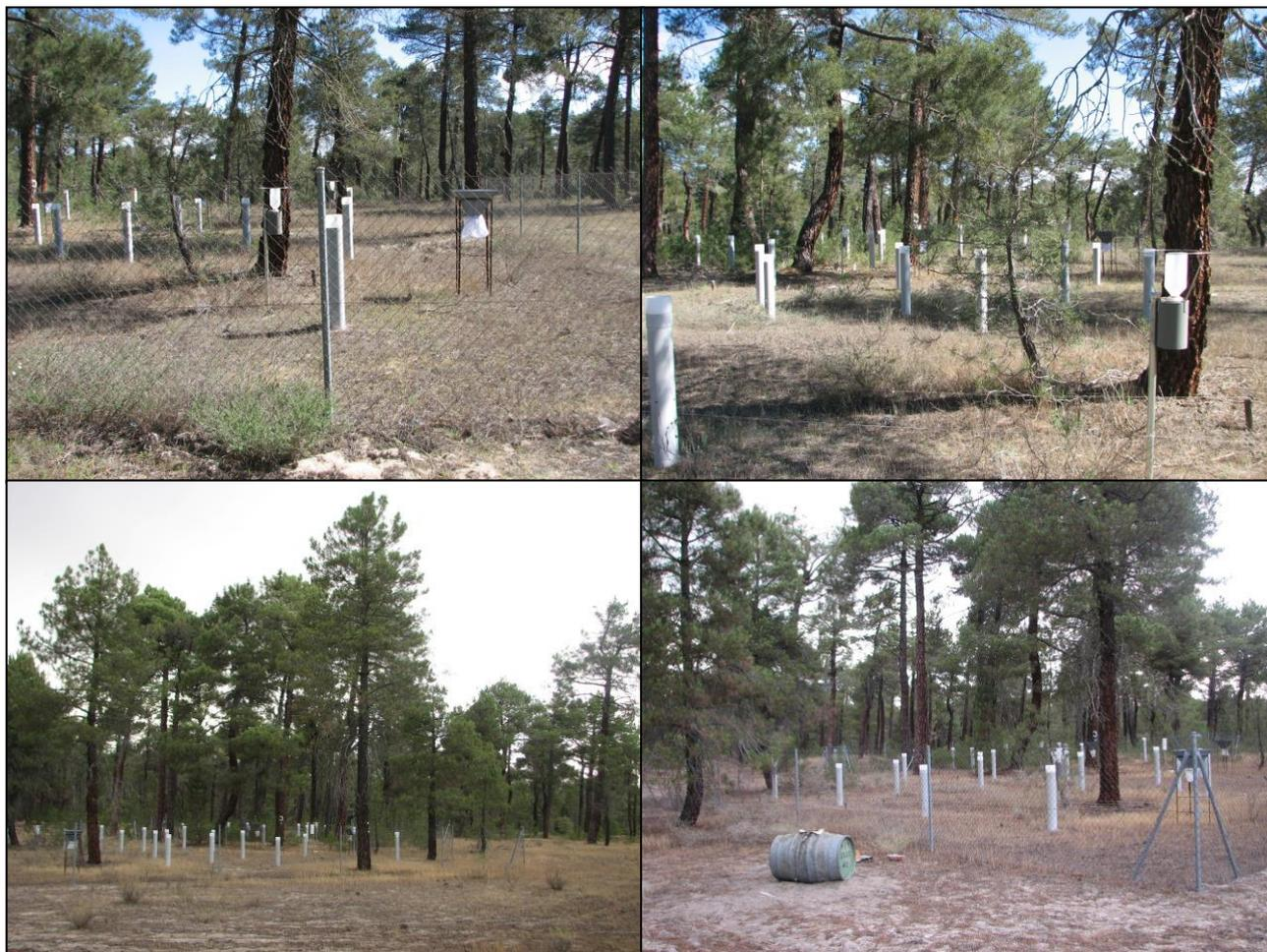
**FIG 7:** Parcela interior. Acumuladores de deposición. Captador de desfronde. Sonda de humedad. Pluviómetros
