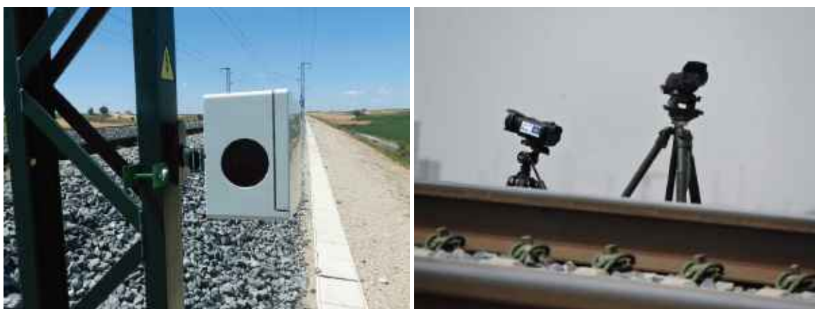
Figura 15.2. Videocámara en poste de catenaria y videocámaras en traza del AVE para conocer la siniestralidad asociada a este tipo de vías. Foto: Life Impacto Cero (LIFE12 BIO/ES/0000660).
