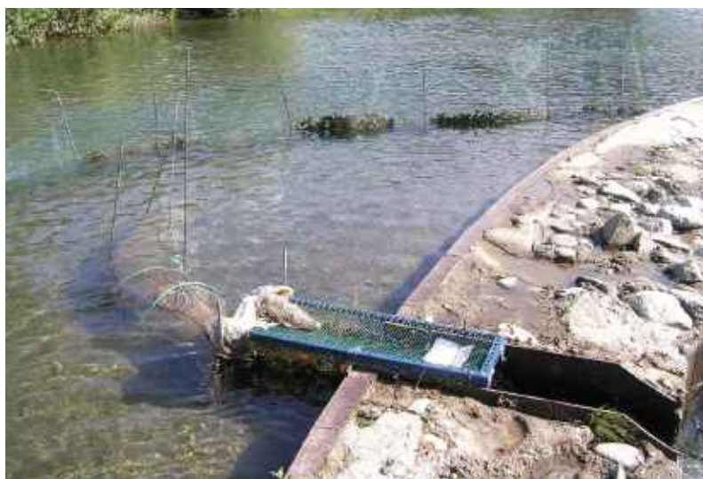
Figura 10.1. Imagen y representación esquemática de la colocación de las nasas para el seguimiento de las estructuras de paso y su uso por parte de la ictiofauna. La imagen muestra el seguimiento con nasa de un dispositivo de paso para peces situado en un azud en el que los animales son dirigidos mediante una estructura rígida. Se coloca una valla adicional para retener hojas y otros materiales. Foto: Quim Pou (CERM). El esquema representa en rojo la estructura (drenaje o paso de otro tipo) y en azul la nasa (triángulo alargado) con dos alas alineadas con la estructura para dirigir la fauna a su interior. En el caso de usar esta metodología para estimaciones de abundancia, es preferible el uso de una sola ala para no excluir los peces que nadan por el exterior.
