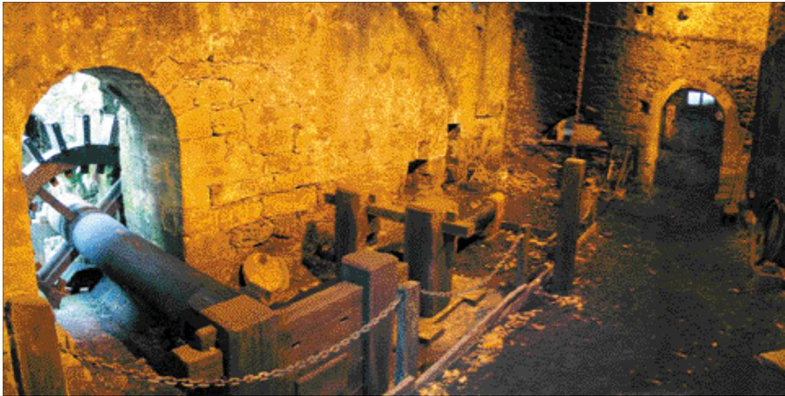
Figura 96. Aspecto interior de la ferrería de Cades (Valle de las Herrerías). Llegó a ser una de las más importantes de Cantabria a mediados del siglo XVIII. Dos enormes ruedas dentadas eran impulsadas por el agua de un canal para mover sendos mecanismos: por una parte, el enorme martillo pilón que golpearía el hierro; por otra, los dos fuelles que avivarían las brasas en que éste se calentaba.
