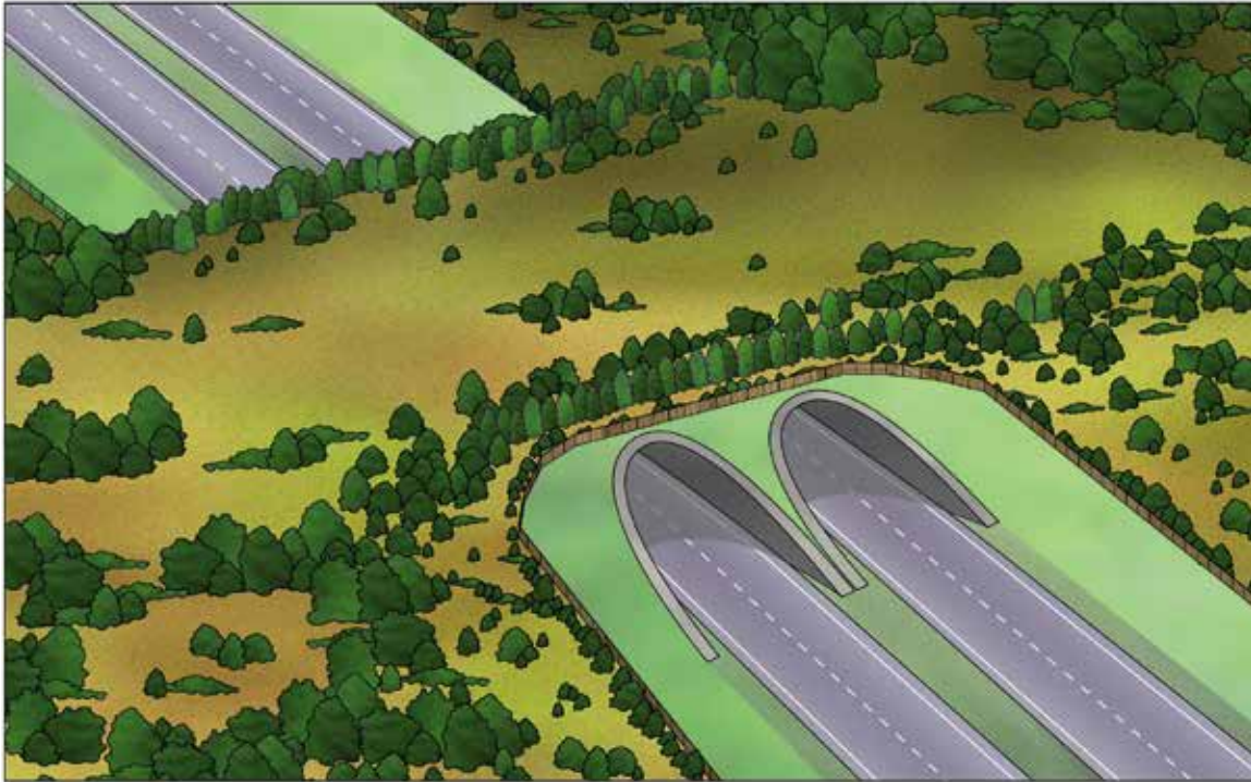
Figura 1.1. Esquema general de un ecoducto.
