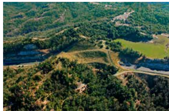
Figura 1.4. La superficie y los accesos del ecoducto deberán tener perfiles topográficos similares a los del paisaje del entorno. Foto: Minuartia.
