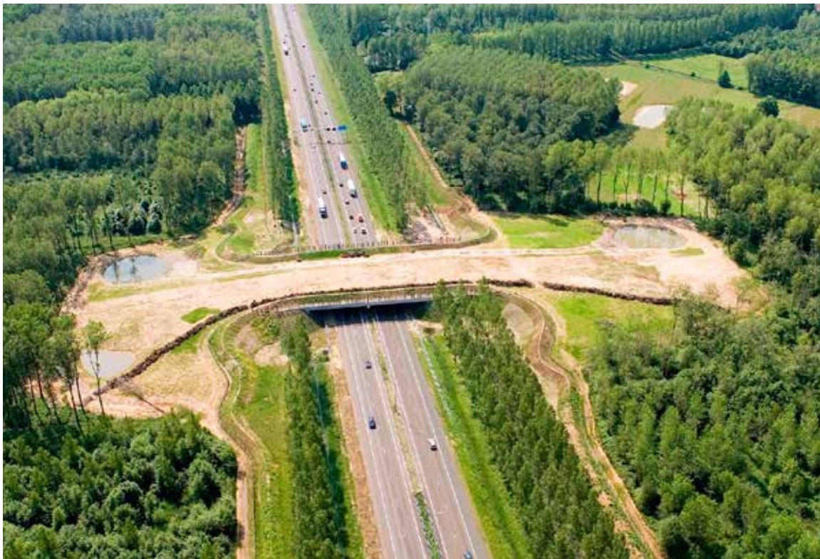
Figura 12.2. Acondicionamiento de accesos de un ecoducto que combina motas de tierra e hileras de ramas que facilitan refugios y conducen a los animales hacia la estructura. Las balsas también tienen la función de atraer a la fauna. Foto: H. Bekker.
