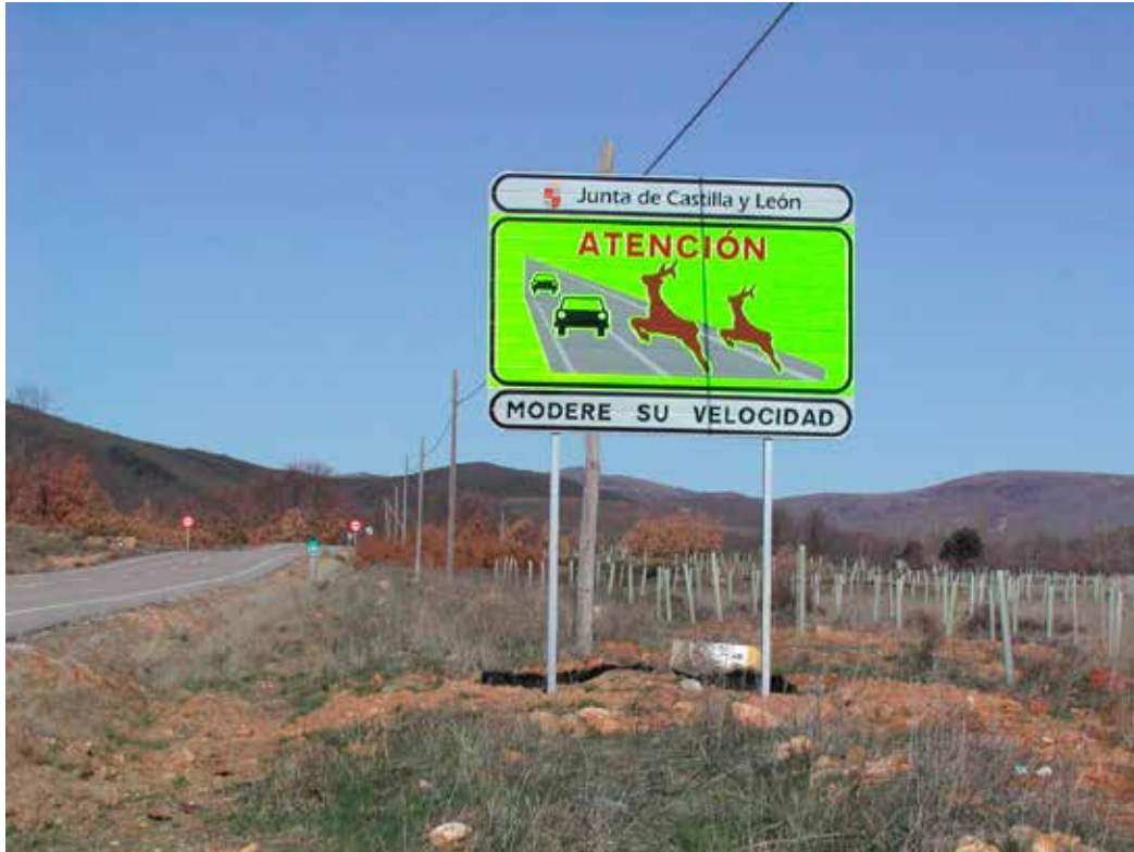
Figura 17.1. El mensaje de advertencia se ha destacado mediante un panel con fondo amarillo fluorescente. Foto: Consejería de Fomento y Medio Ambiente, Junta de Castilla y León.
