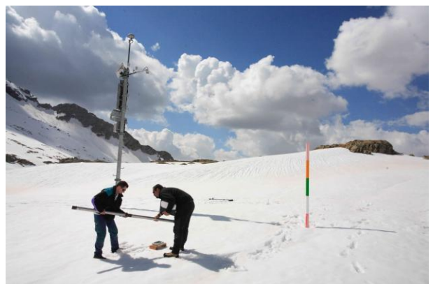
Primeras calibraciones telenivómetros Pirineo. Ordiceto, Cinca. 2007
