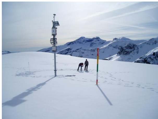
Calibración del telenivómetro de Fuentes Carrionas. Cantábrica 2009
