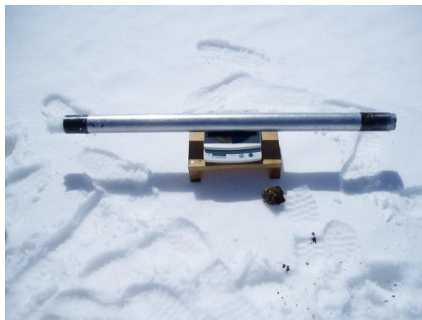
Ensayo de densidad. Bachimaña, Gállego. Pirineo 2008
